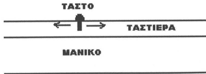
Σχήμα 33, Εικονική αναπαράσταση δυνάμεων που ασκούνται στην ταστιέρα κατά την τοποθέτηση τάστων
