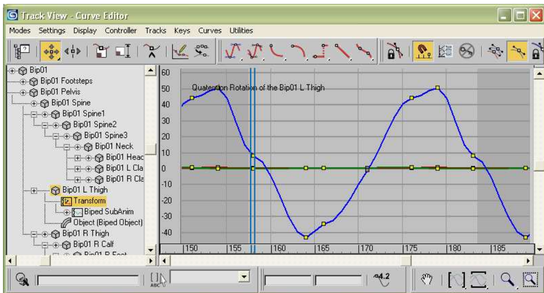
Σχήμα 4-14: Διάγραμμα για τη γωνία περιστροφής του αριστερού μηρού ως προς το χρόνο για το μοντέλο «Human». Με κόκκινη γραμμή βλέπουμε την περιστροφή ως προς τον άξονα x, με πράσινη ως προς τον άξονα y και με μπλε ως προς τον άξονα z. Αριστερά διακρίνεται μέρος της ιεραρχίας των οστών.
