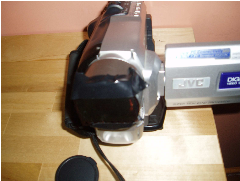
Εικ.40 Εφαρμόζουμε το φίλτρο και με μαύρη ταινία (tape) διασφαλίζουμε ότι δεν περνάει άλλο φως.
