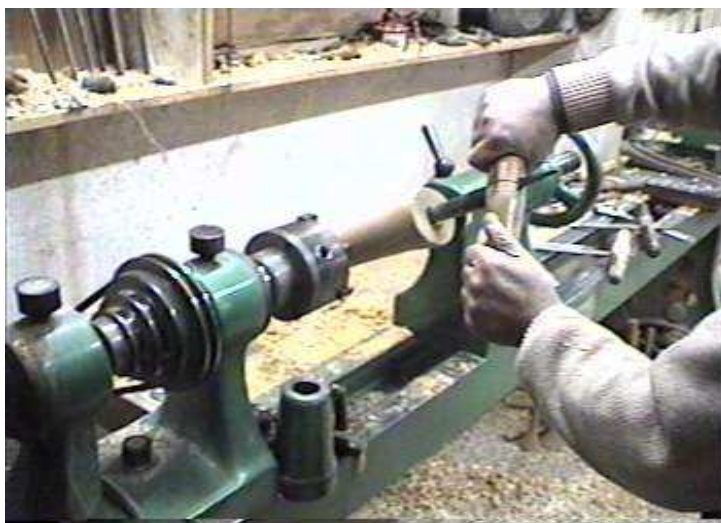
Εικόνα 2.18: Δημιουργία πειραματικής οπής
