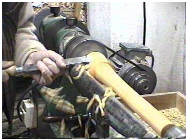
Εικόνα 2.20: Διαμόρφωση εξωτερικής όψης ζουρνά
