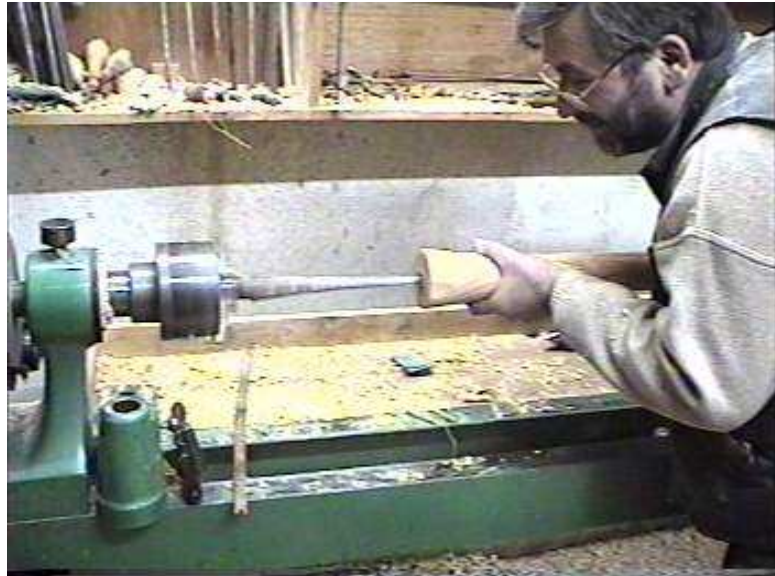
Εικόνα 2.19: Διαμόρφωση εσωτερικής όψης
