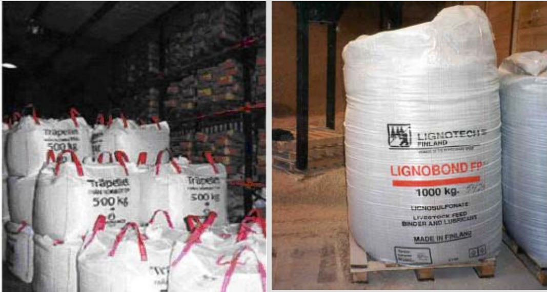
Εικόνα 2.5 Οικονομική συσκευασία συσσωματωμάτων βιομάζας pellets 500kg και 1000kg.
