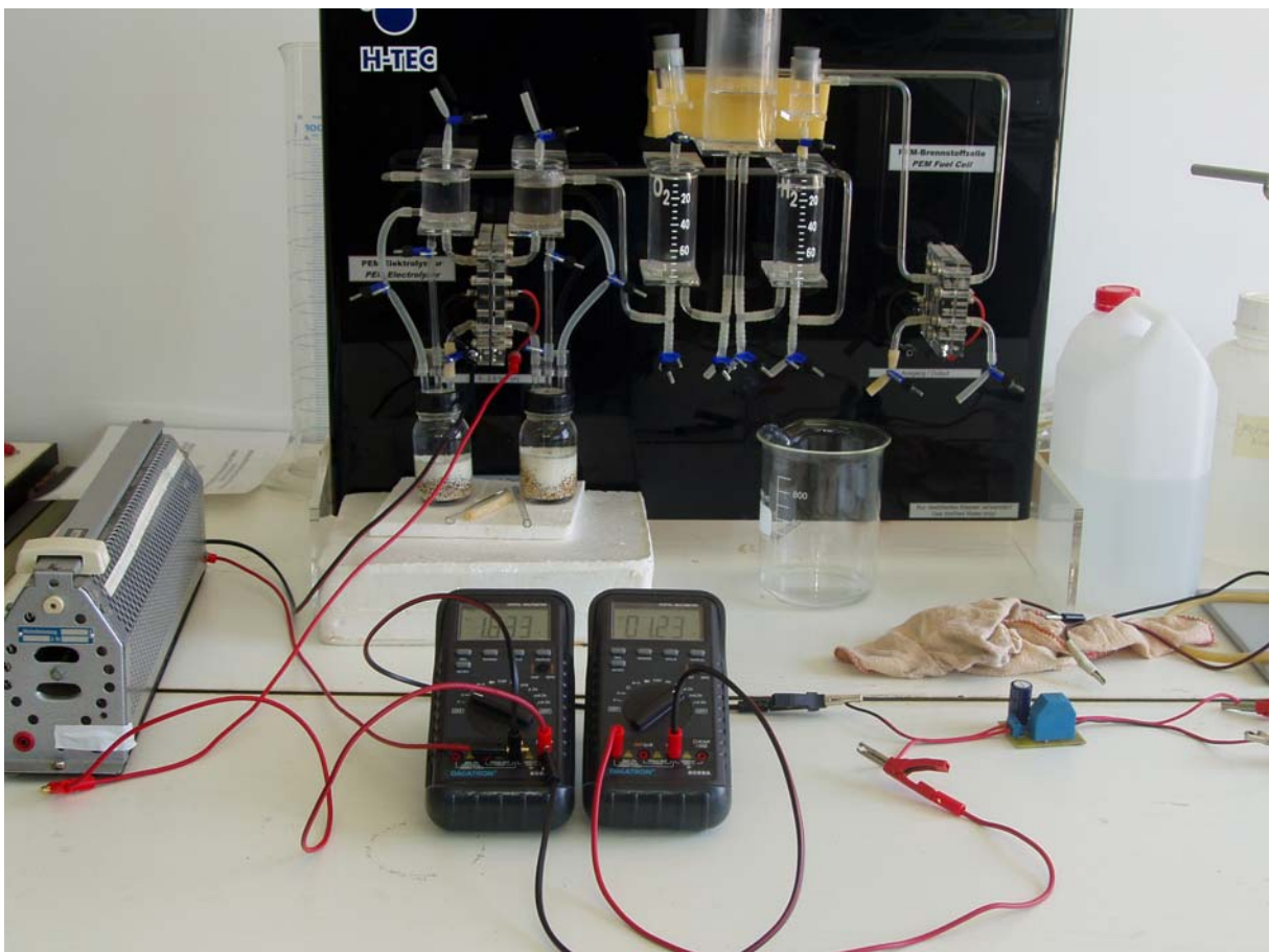
Σχήμα 6.1: Διαδικασία Ηλεκτρόλυσης Σε Πλήρη Λειτουργία
