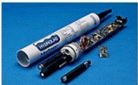
Σχήμα 6.2: Το πολυόργανο Surveyor 4 και ο πολυαισθητήρας που διαθέτει.
