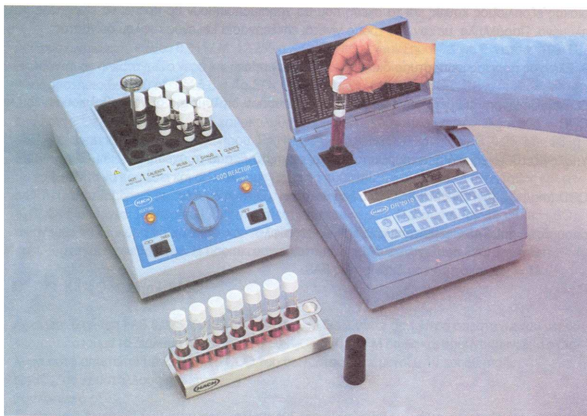
Σχ.6.2. Απαιτούμενος εξοπλισμός για τον προσδιορισμό του COD φασματοφωτομετρικά με την μικρο-μέθοδο[6].
