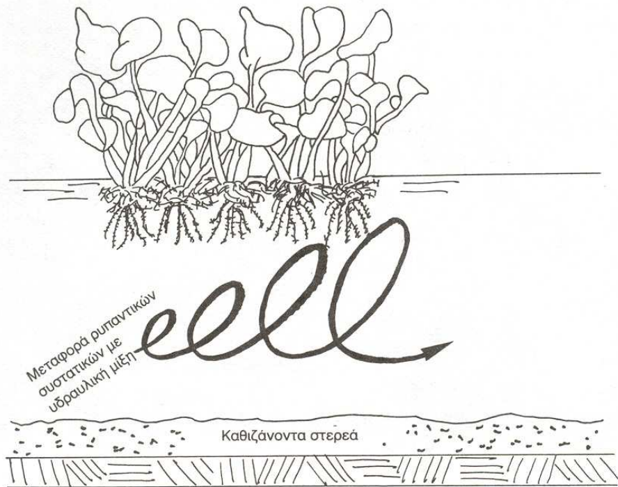
Σχ.4.19. Σχηματική ροή μεταφοράς και μίξης του υγρού απόβλητου στη ζωή ριζών ενός συστήματος φυτών υακίνθου νερού[3].
