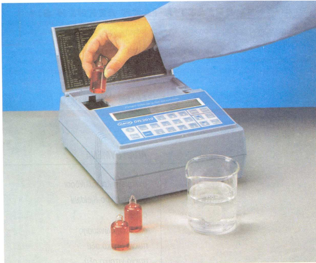
Σχ.6.4. Φορητό φασματοφωτόμετρο για άμεσο προσδιορισμό ορθοφωσφορικών με έτοιμη καμπύλη αναφοράς[6].
