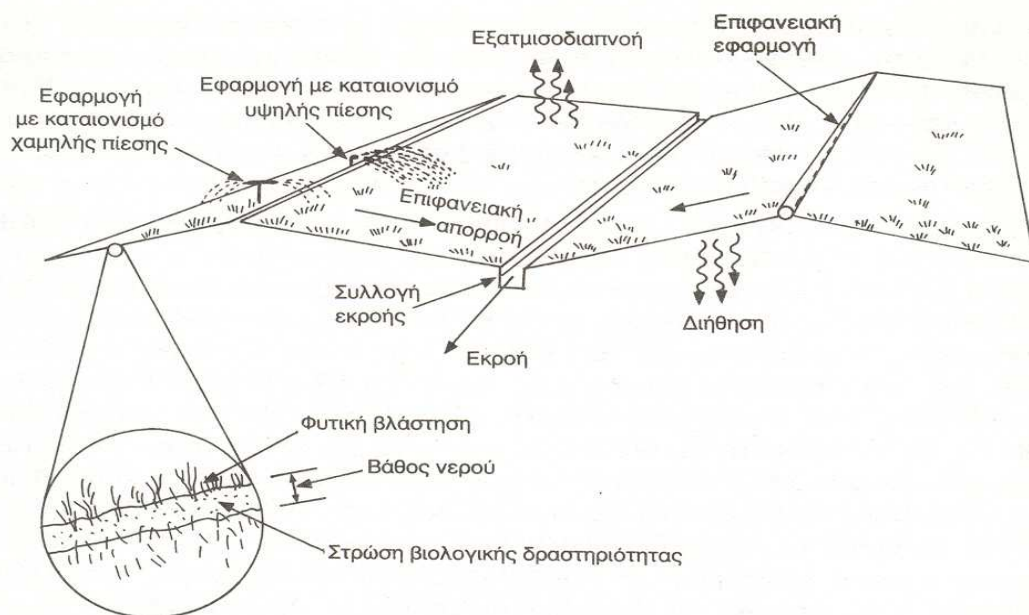
Σχ.4.4. Σχηματική αναπαράσταση των διεργασιών ενός συστήματος επιφανειακής ροής[3].
