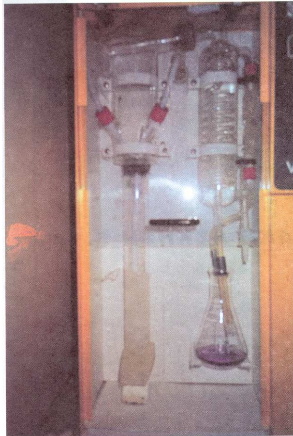
Σχ.6.3.(α) Αυτόματη συσκευή απόσταξης για τον ογκομετρικό προσδιορισμό της αμμωνίας[6].
