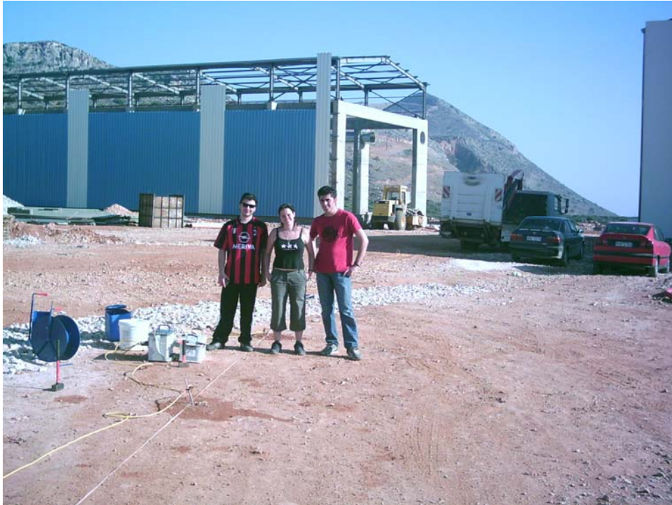
Σχήμα 60. Εδώ απεικονίζεται η 1 η γραμμή. Όπως διακρίνουμε τα σημεία που έχουν τοποθετηθεί τα ηλεκτρόδια έχουν καταβρεχθεί με αλατόνερο, επειδή λόγω της ξηρασίας που επικρατούσε, δεν ήταν δυνατή η καταγραφή των αντιπροσωπευτικών τιμών των ειδικών αντιστάσεων.
