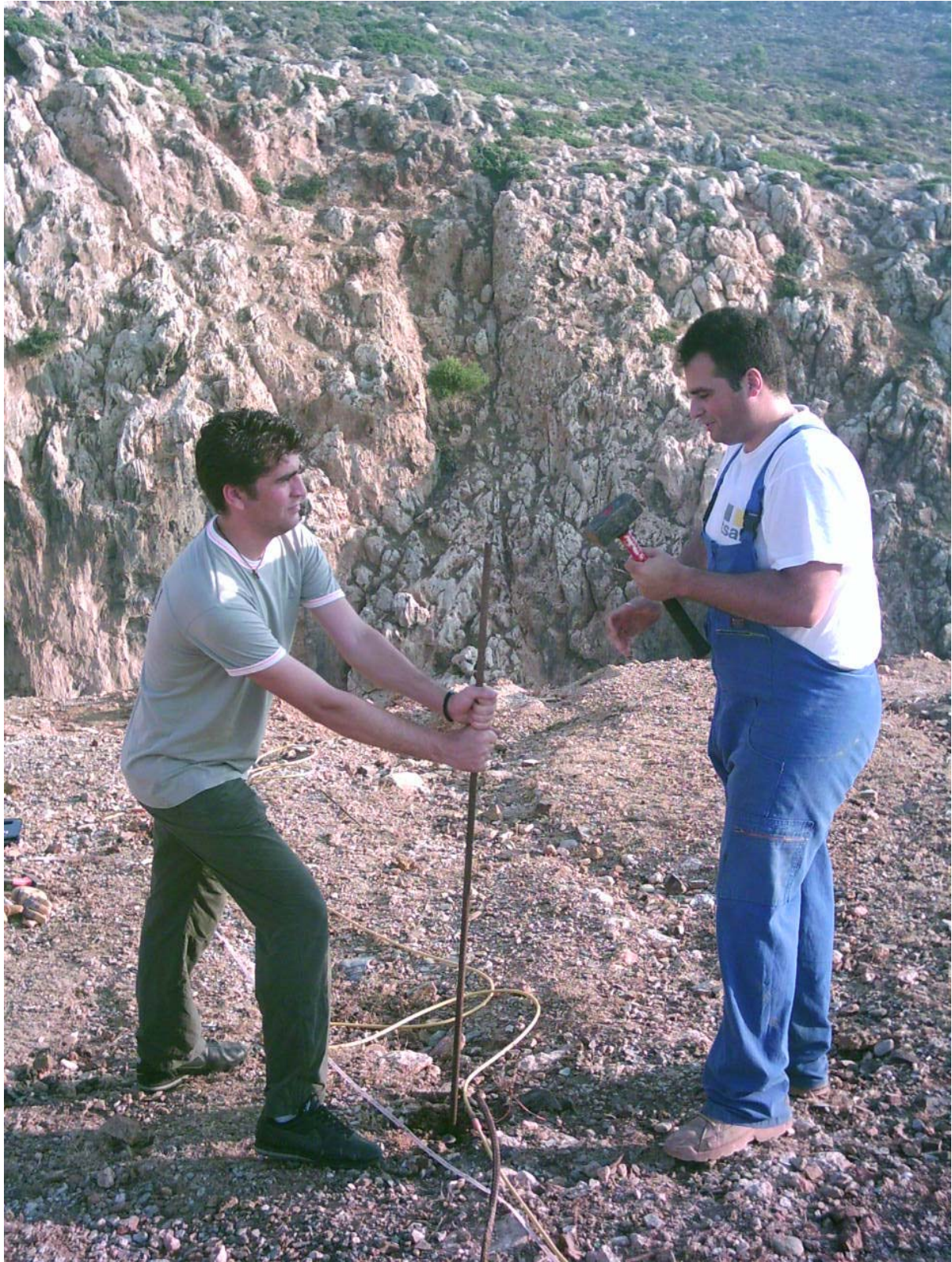
Σχήμα 74. Τα ηλεκτρόδια που χρησιμοποιήθηκαν στην 4 η και 5 η τομή είχαν μήκος 2m.
