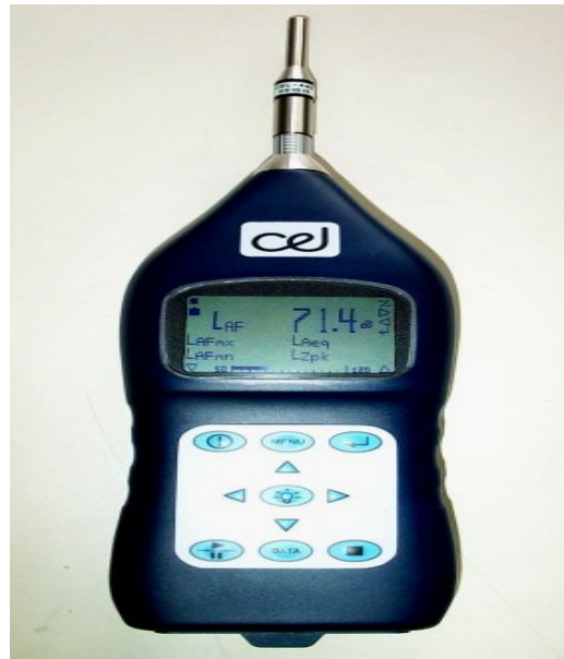
Σχήμα 5: Ηχώμετρο τύπου CEL-440
