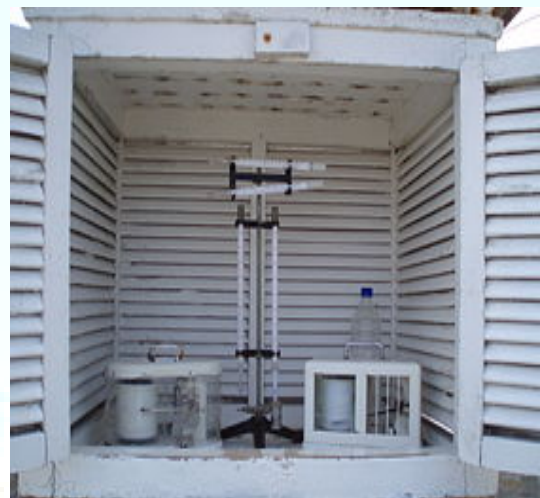
Εικόνα 11: Εξωτερική όψη του Μετεωρολογικού κλωβού (αριστερά) και η διάταξη των Μετεωρολογικών οργάνων στο εσωτερικό του κλωβού (δεξιά) Μ.Σ. Χανίων.
