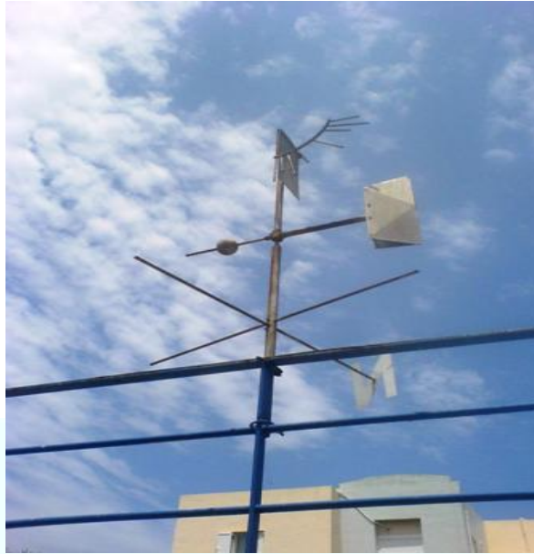
Εικόνα 18: Ιστορικό ανεμόμετρο με ανεμοδείκτη του Μ.Σ. Χανίων με ένδειξη μέτρησης στην κλίμακα Beaufort.
