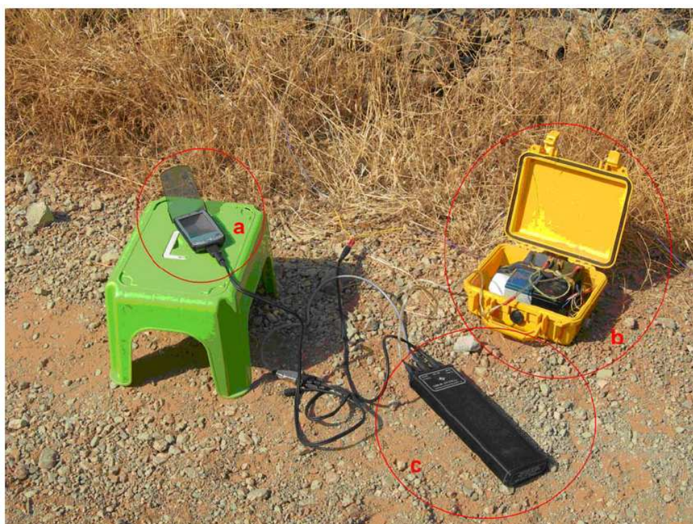
Εικόνα 8: όργανα TEM και περιφερειακές μονάδες α) υπολογιστής παλμόμετρο β) εξωτερικό τροφοδοτικό (12 V+12V σε σειρά=24V ) γ) σύστημα TEM Fast 48 .
