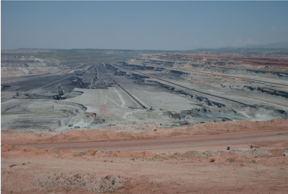
Φωτογραφία 1: Επιφανειακό λιγνιτωρυχείο με καδοφόρους εκσκαφείς. Δεξιά το κοιτάσμα λιγνίτη, αριστερά οι αποθέσεις στείρων
