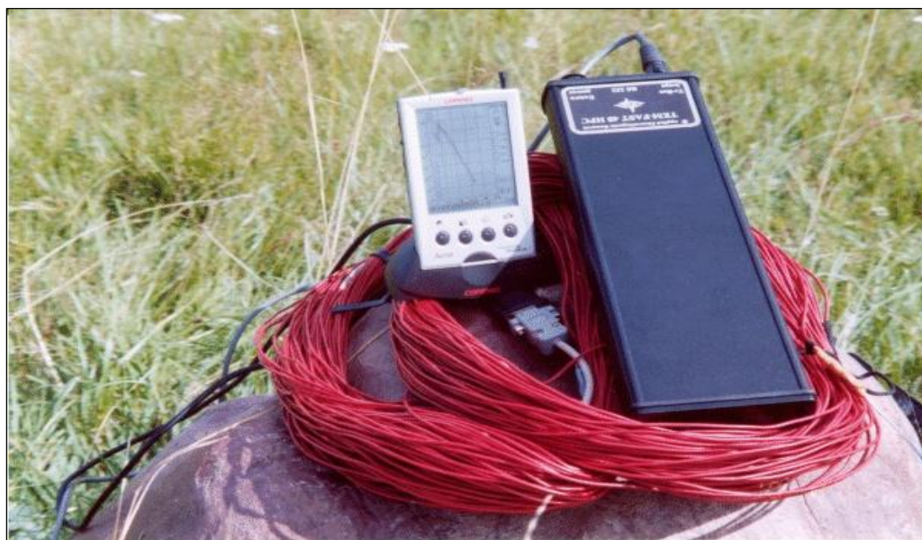
Εικόνα 3.10: Δείγμα οργάνου TEM- FAST 48 (APPLIED ELECTROMAGNETIC RESEARCH (AEMR) TEM -FAST 48HPC, aemr.net, 2010)
