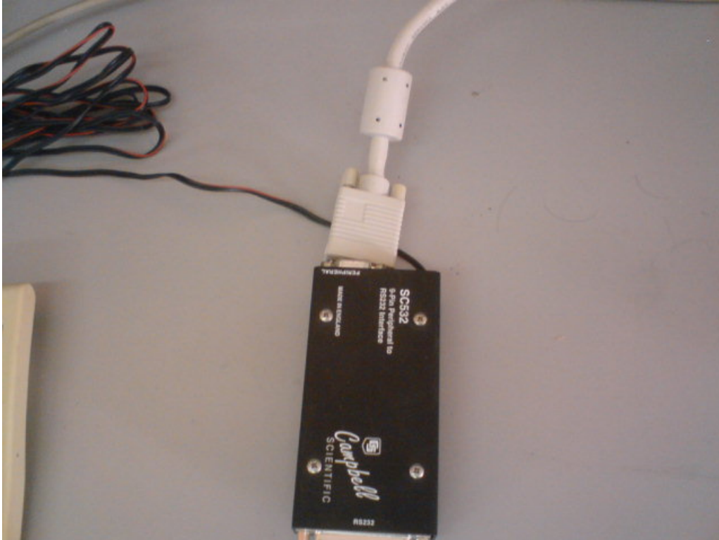
Σχήμα 32. RS-232 interface Campbell Scientific SC532
