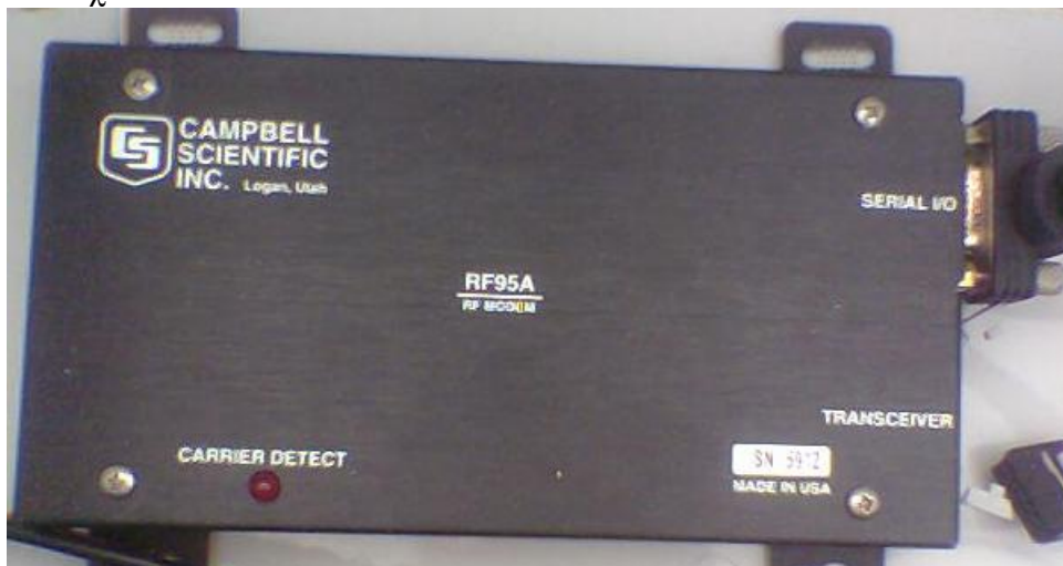
Σχήμα 31. Campbell Scientific RF95 ραδιο-μόντεμ
