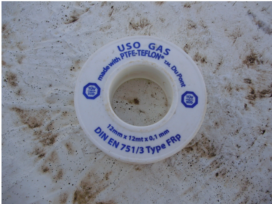
Εικόνα 4.21 Κατάλληλο τεφλόν για στεγανοποίηση των σπειρωμάτων.
