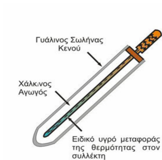
Εικόνα 6.2 Λεπτομερείς περιγραφή σωλήνας κενού.
