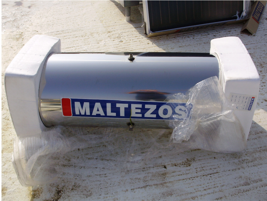
Εικόνα 4.20 Άνοιγμα της δεξαμενής αποθήκευσης(μπόιλερ) και έλεγχος για τυχόν χτυπήματα.
