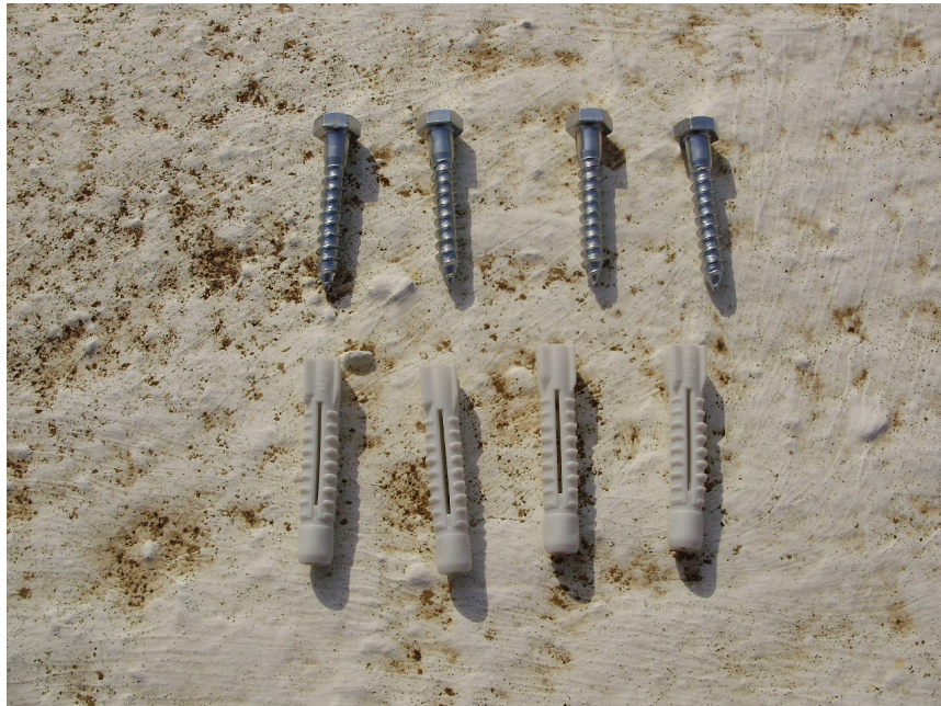
Εικόνα 4.18 Στριφόνια και ούπα(12mm) για την στήριξη της βάσης στο μπετόν της ταράτσας.
