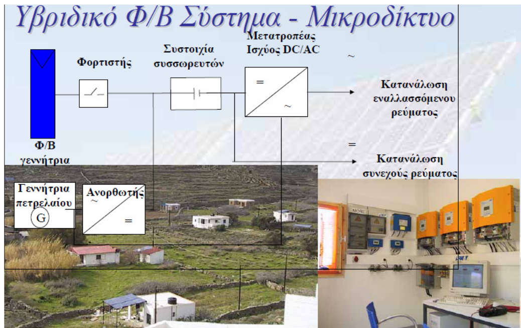
Σχήμα 3.6: Απεικόνιση υβριδικού Φ/Β συστήματος με μορφή απλού διαγράμματος
