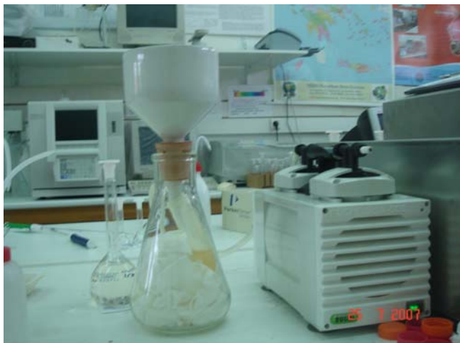
Εικόνα 3.3 Αντλία κενού και χωνί Buchner
