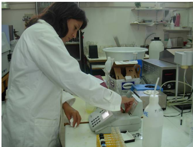
Εικόνα 19: Τοποθέτηση κυψελίδας αναγνώρισης στο φωτόμετρο MERCK Spectroquant NOVA 60.
