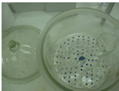
Εικόνα 11: Ξηραντήρας με Silica Gel και ποτήρια ζέσεως κατά την διαδικασία προσδιορισμού των ολικών στερεών.
