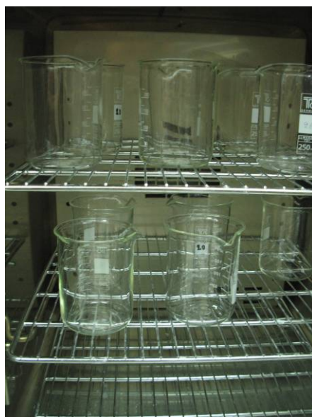
Εικόνα 10: Ποτήρια ζέσεως στον φούρνο ξήρανσης κατά τον προσδιορισμό ολικών στερεών.
