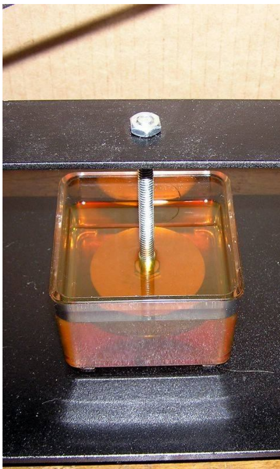
Σχήμα 4.6 Απόσβεση με υγρό
