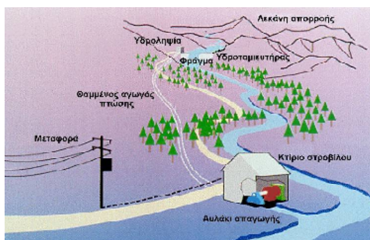
Σχήμα 2.3.2.. Παράσταση ενός ΜΥΗ μεγάλου ύψους πτώσης(2)
