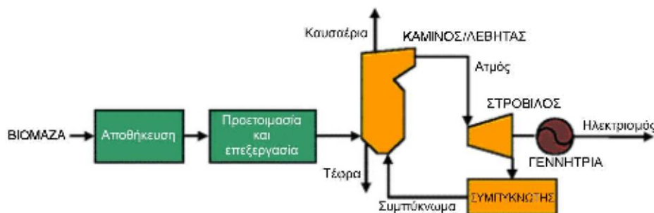
Σχήμα 2.3. Σύστημα ατμοστροβίλου άμεσης καύσης(2)
