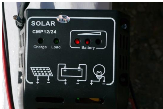
Φωτογραφία του ελεγκτη φόρτισης με αναμμένη την ένδειξη πληρότητας και ελέγχου της μπαταρίας.
