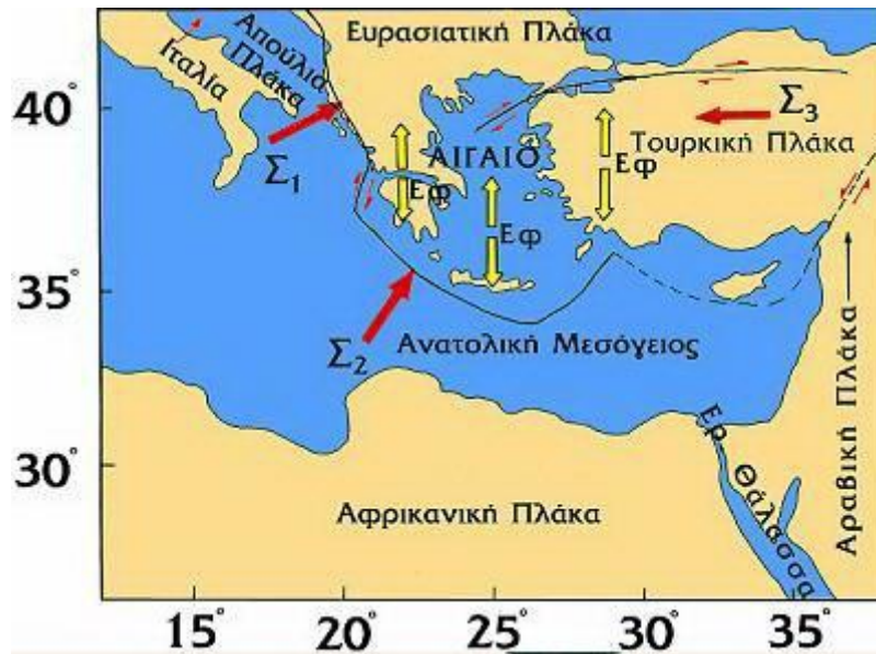
Σχήμα 4.1.3 Σχηματική αποτύπωση των δυνάμεων που ασκούνται στη λιθόσφαιρα του Αιγαίου. Οι συμπιεστικές δυνάμεις Σ1, Σ2 και Σ3 που ασκούν οι γειτονικές λιθосφαιρικές πλάκες στη λιθόσφαιρα του Αιγαίου απεικονίζονται με τα κόκκινα βέλη. Οι εφελκυστικές δυνάμεις που ασκούνται στην κάτω επιφάνεια της λιθόσφαιρας με τα κίτρινα βέλη (Παπαζάχος Β., 1989).
