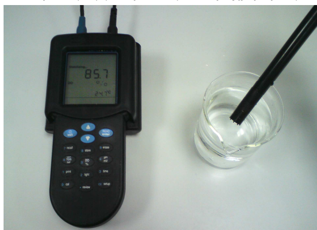
Εικόνα 68: Ηλεκτρόδιο μέτρησης οξυγόνου
