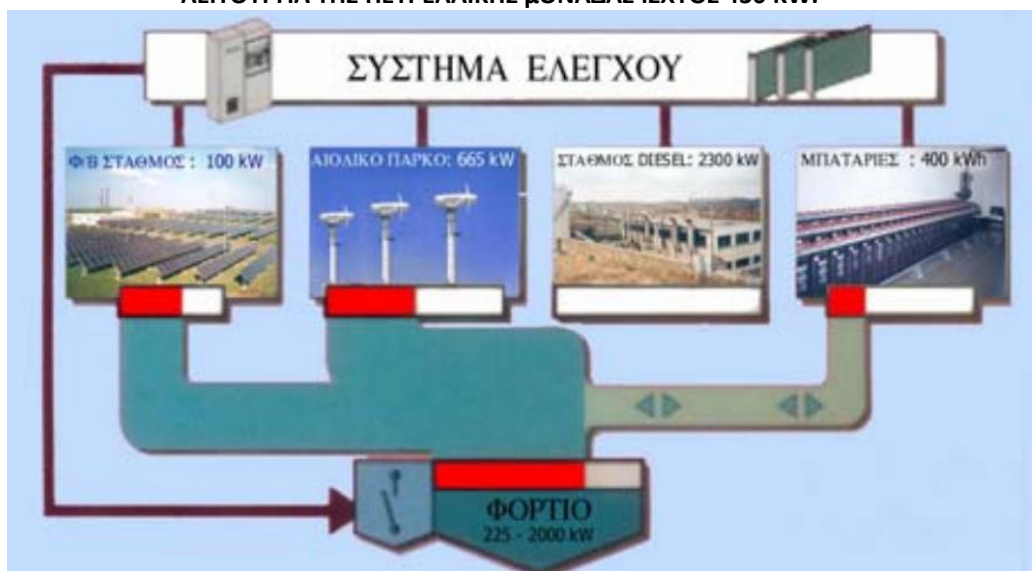
ΕΙΚΟΝΑ 5.8: ΣΧΗΜΑΤΙΚΗ ΠΑΡΑΣΤΑΣΗ ΛΕΙΤΟΥΡΓΙΑΣ ΤΟΥ ΥΒΡΙΔΙΚΟΥ ΣΥΣΤΗΜΑΤΟΣ ΤΗΣ ΚΥΘΝΟΥ ΜΕ ΚΑΛΥΨΗ ΤΩΝ ΑΝΑΓΚΩΝ ΤΟΥ ΝΗΣΙΟΥ 100 % ΑΠΟ ΑΠΕ . (ΠΕΤΡΕΛΑΪΚΕΣ ΜΟΝΑΔΕΣ ΕΚΤΟΣ ΛΕΙΤΟΥΡΓΙΑΣ)
