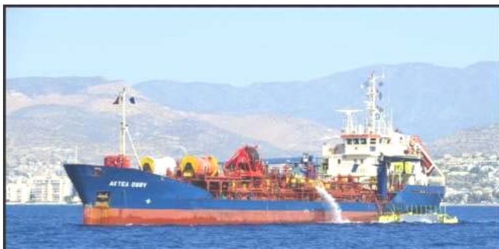
Σχήμα 3.12 Σκάφος περισυλλογής (Μαρίνος Ιωάννου, Προϊστάμενος Ναυτικής Υπηρεσίας, Ρύπανση της θάλασσας από πετρελαιοειδή)
