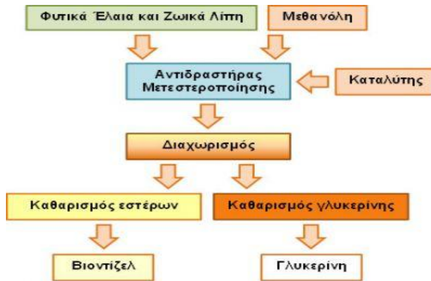
Σχήμα 11: Διαδικασία παραγωγής βιοντίζελ
