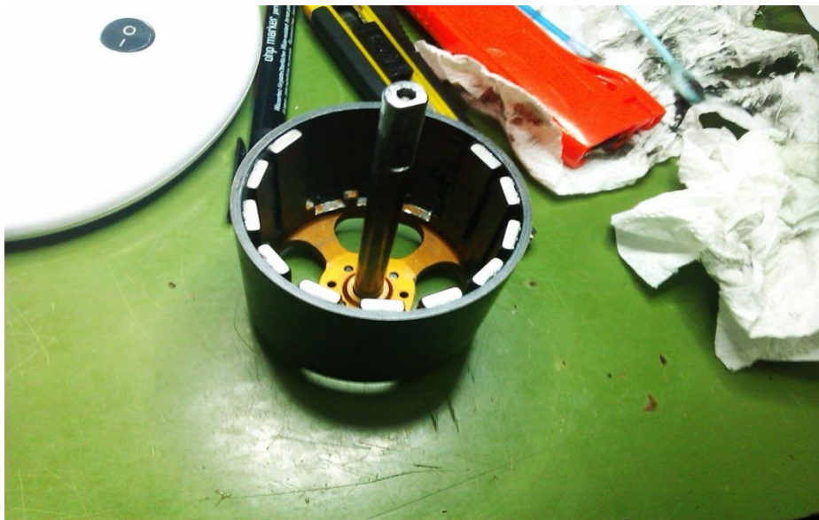
Εικόνα.2: Ο ρότορας κατά την τοποθέτηση μόνιμων μαγνητών με εποξική κόλλα.
