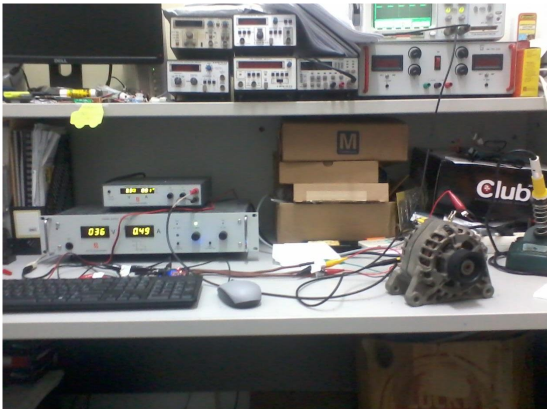
Εικόνα.10: Οτρισφασικός αντιστροφέας με τον DRV8301 εν λειτουργία.
