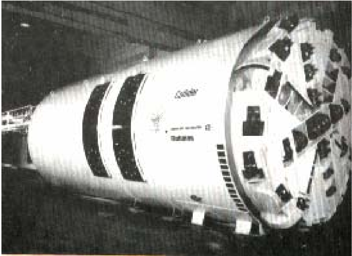
Σχήμα 30α. Μηχάνημα Robbins διπλής τηλεσκοπικής ασπίδας με δυο σειρές πεδίων στηρίξεως για συνεχή λειτουργία.
