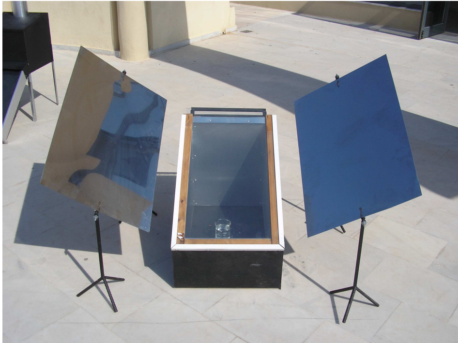
Εικόνα 2.1 Ηλιακό μαγειρείο τύπου κουτιού με ανακλαστικά κάτοπτρα(ΗΜ 1)
