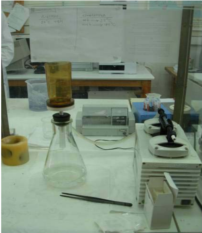
Εικόνα 27. Αντλία κενού και αποστειρωμένα μαγνητικά φίλτρα Gelman.
