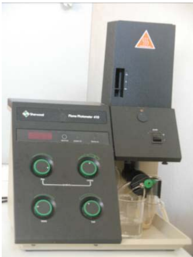
Εικόνα 26. Φώτο-ανιχνευτής Sherwood flame Photometer 410 που χρησιμοποιήθηκε για την ανίχνευση συγκέντρωσης νατρίου, καλίου και ασβεστίου.
