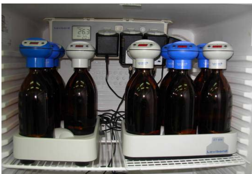
Εικόνα 24. Φιάλες B.O.D. τοποθετημένες στον θάλαμο επώασης.
