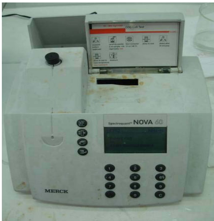
Εικόνα 25. Φωτόμετρο MERCK Spectroquant NOVA 60.
