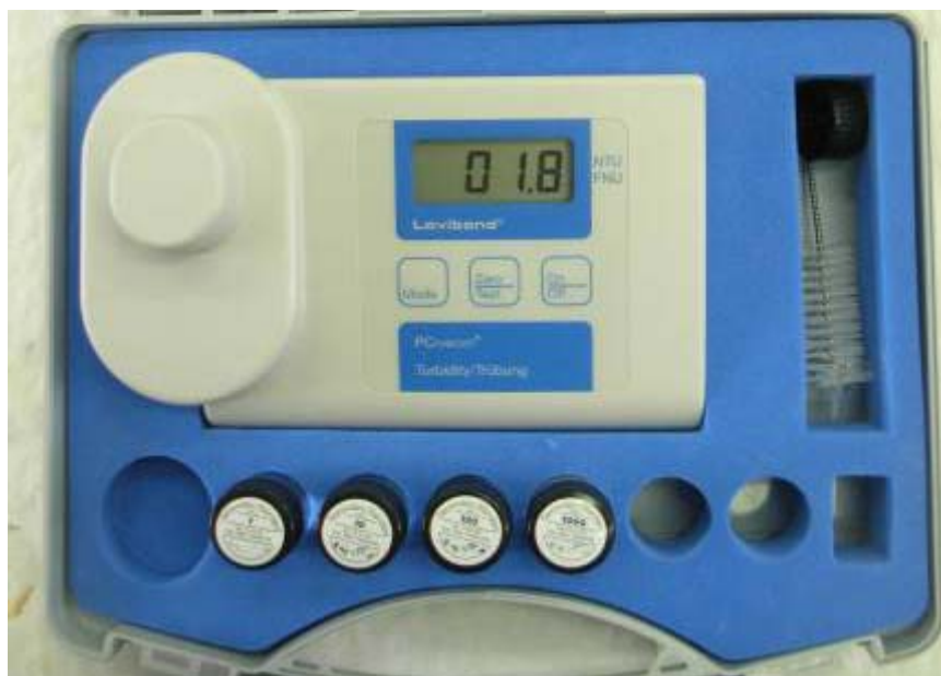
Εικόνα 19. Φορητό θολερόμετρο (Lovibond CR3210).
