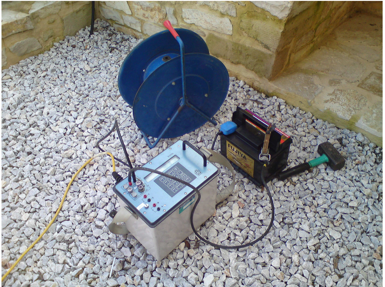
Εικόνα 4.1: Φωτογραφία του οργάνου μέτρησης της αντίστασης του εδάφους SYSCAL Pro (αριστερά πάνω) και του πολυπλέκτη SYSCAL Switch Pro (δεξιά πάνω). Τρόπος σύνδεσης του οργάνου SYSCAL Pro με τον πολυπλέκτη για την αυτόματη μέτρηση και καταγραφή της φαινόμενης αντίστασης του υπεδάφους (κάτω).
