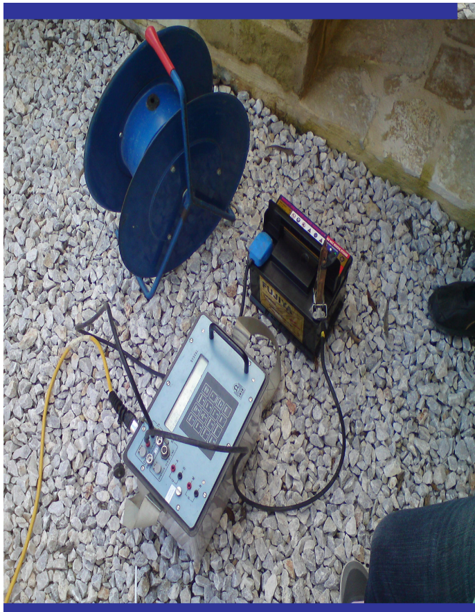
Όργανο παραγωγής δονήσεων. Μπαταρία και συνδεσμολογία
