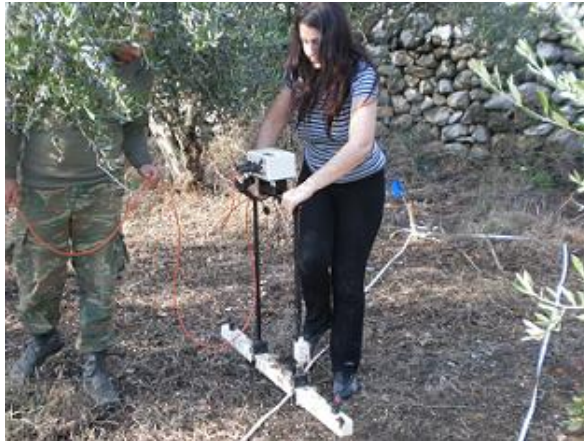
Σχήμα 2.2 Ηλεκτρομαγνητική διασκόπηση για χαρτογράφηση αρχαιολογικού χώρου
