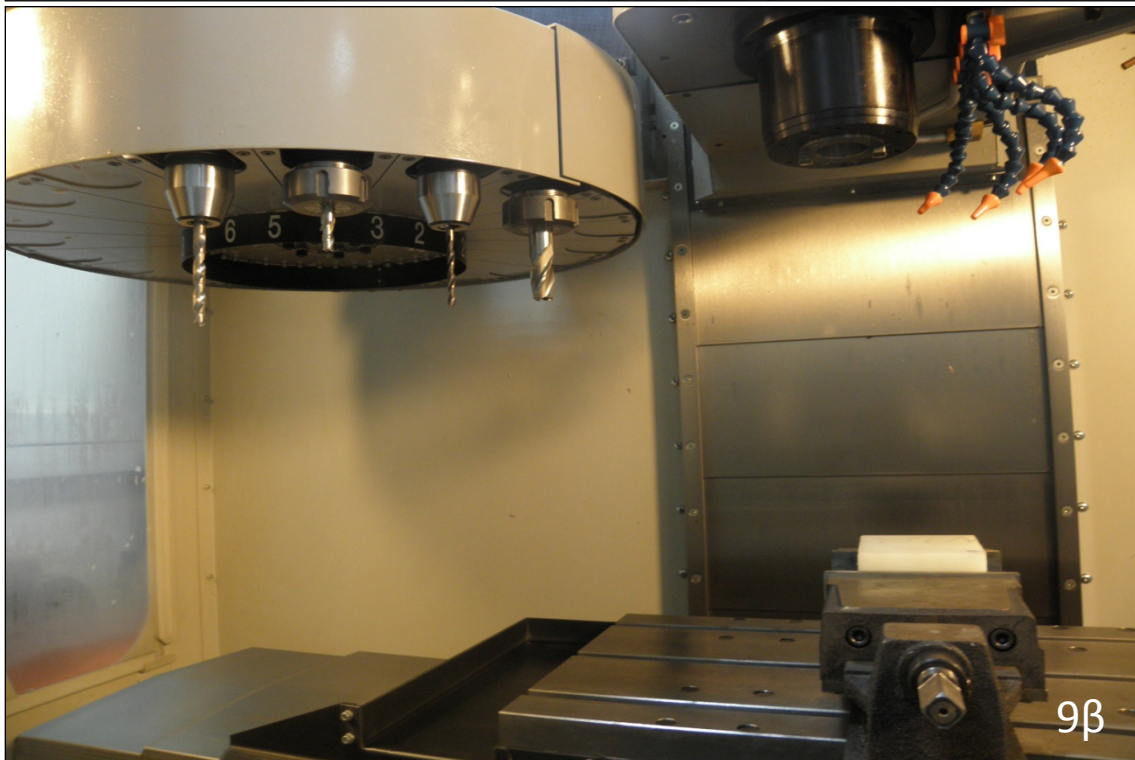
Εικόνα 9. Μύλος ή εργαλειοφορέας: (α) Σύστημα εναπόθεσης κώνων (β) τοποθέτηση τεσσάρων κώνων με κοπτικά στις θέσεις 2 έως 6.
