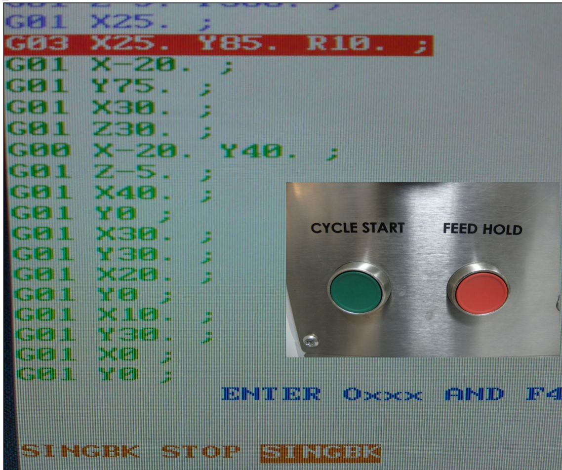
Εικόνα 39. Τρέξιμο κώδικα σε Single Block.
