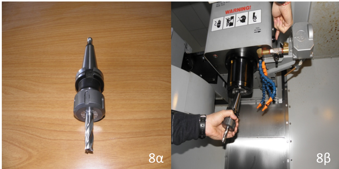
Εικόνα 8. (α) Ολοκληρωμένη εικόνα κώνου με εργαλείο (β) Τοποθέτηση κώνου στην εργαλειομηχανή.
