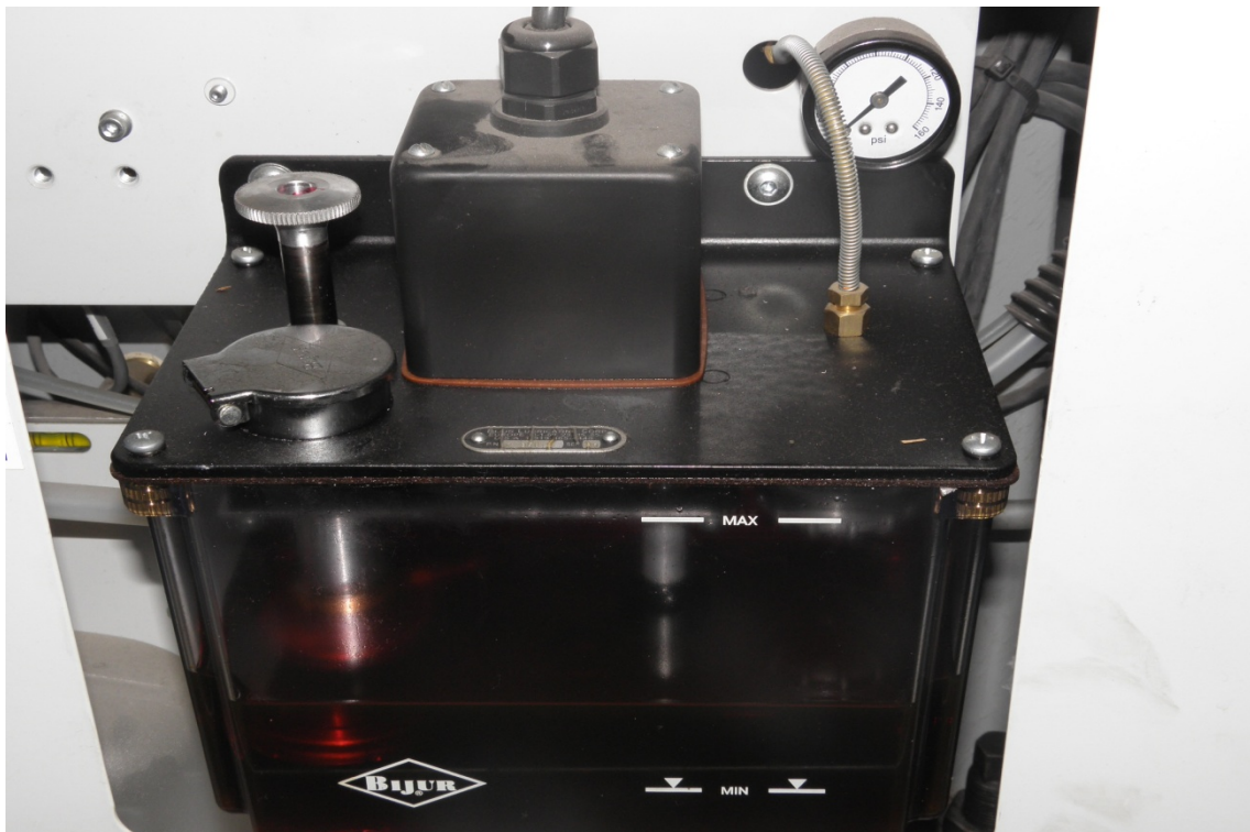
Εικόνα 22. Δεξαμενή αποθήκευσης και ρυθμιστής πίεσης λαδιού.
