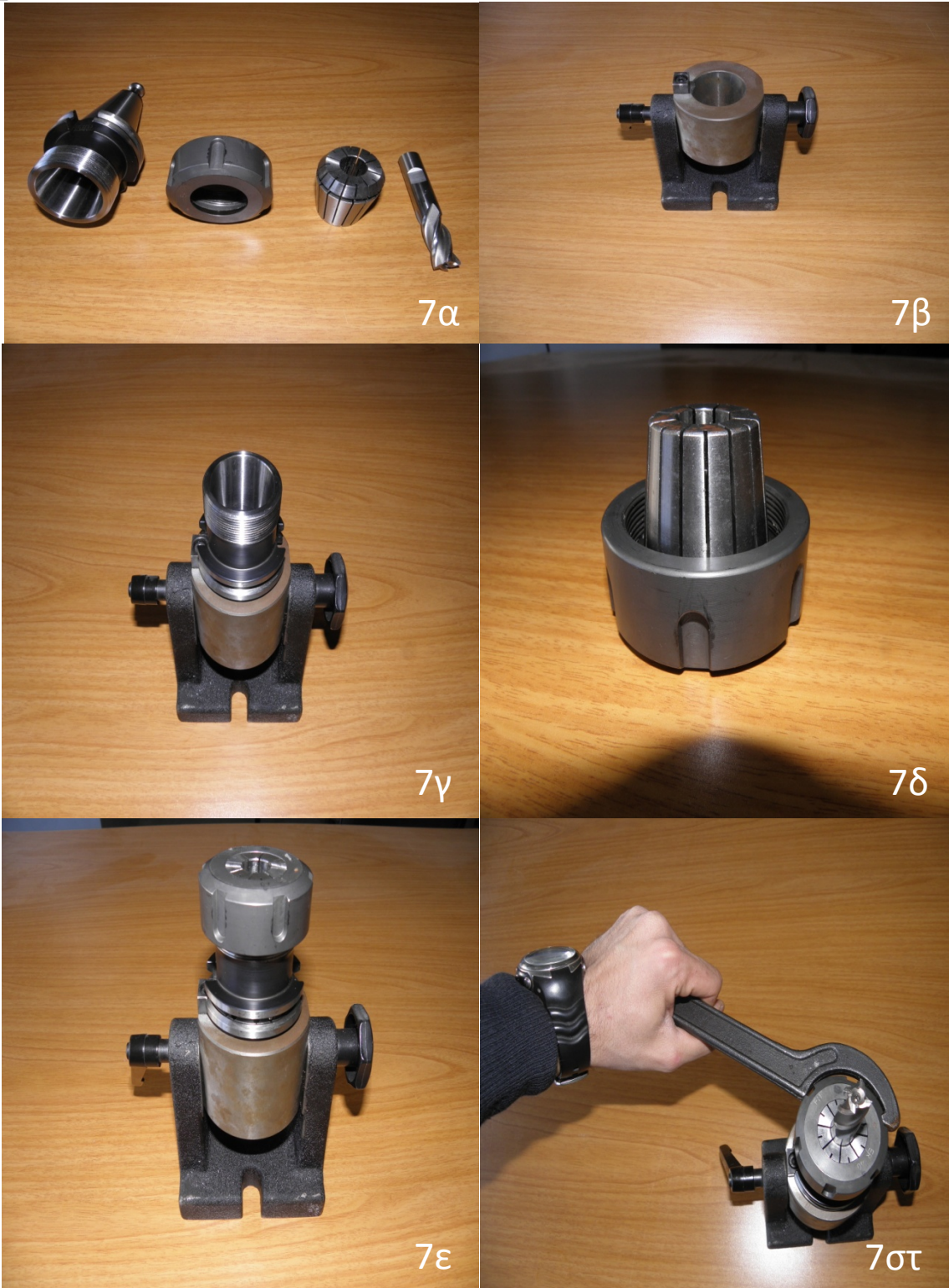
Εικόνα 7. (α) Τα μέρη του κώνου και κοπτικό εργαλείο (β) Μέγγενη κώνων αλλαγής αργαλειών (γ) Τοποθέτηση κώνου στη μέγγενη (δ) Εφαρμογή collet στον δακτύλιο σύσφιξης (ε) Εφαρμογή του δακτυλίου με το collet στον κώνο και (στ) Σύσφιξη εργαλείου με κώνο.
