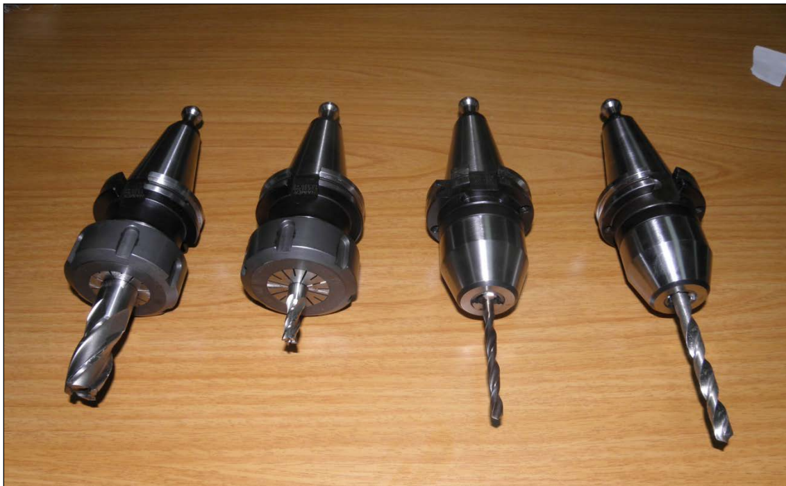
Εικόνα 34. Κοπτικά εργαλεία τοποθετημένα σε κώνους.
