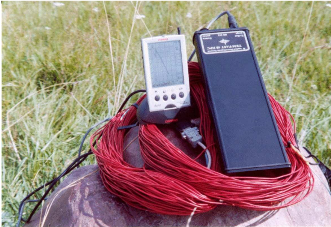
Σχήμα 5.3. Στη σχήμα παρουσιάζεται το TEM Fast 48 HPC, του οίκου AEMR. Το όργανο αποτελείται από τους βρόγχους (κόκκινα καλώδια υψηλής αγωγιμότητας), τη κεντρική μονάδα παραγωγής και διάθεσης των παλμών (συσκευή σε μαύρο χρώμα) και το μονάδα καταγραφής και αποθήκευσης (palmtop – υπολογιστής χειρός).
