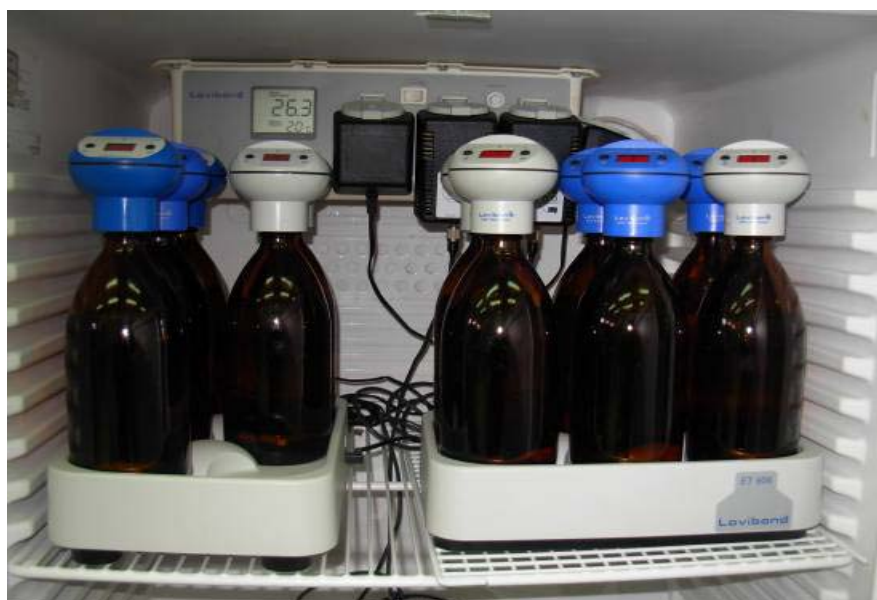
Εικόνα 24. Φιάλες B.O.D. τοποθετημένες στον θάλαμο επώασης.
