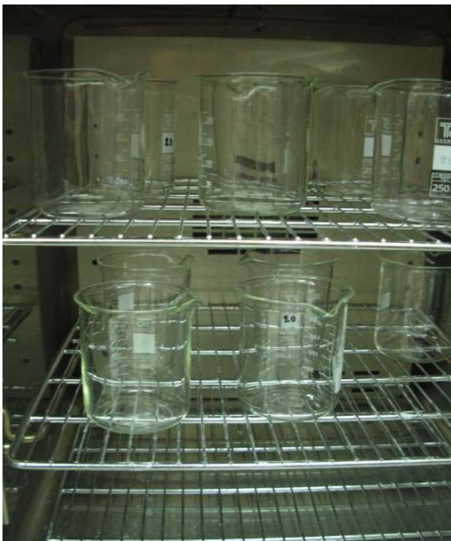
Εικόνα 20. Ποτήρια ζέσεως στον φούρνο ξήρανσης κατά τον προσδιορισμό ολικών στερεών.
