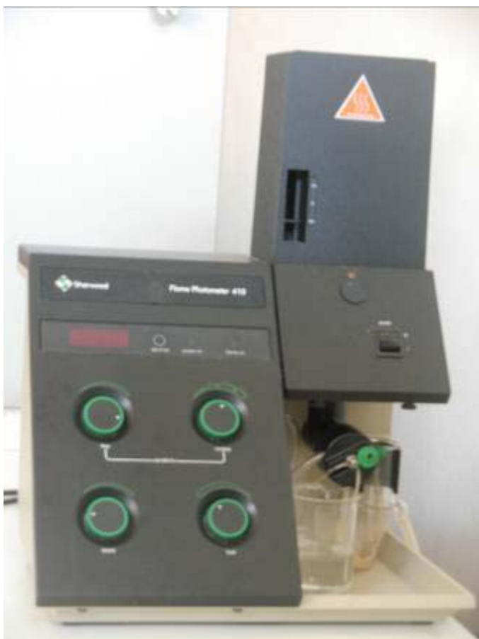
Εικόνα 29. Φώτο-ανιχνευτής Sherwood flame Photometer 410 που χρησιμοποιήθηκε για την ανίχνευση συγκέντρωσης νατρίου, καλίου και ασβεστίου.
