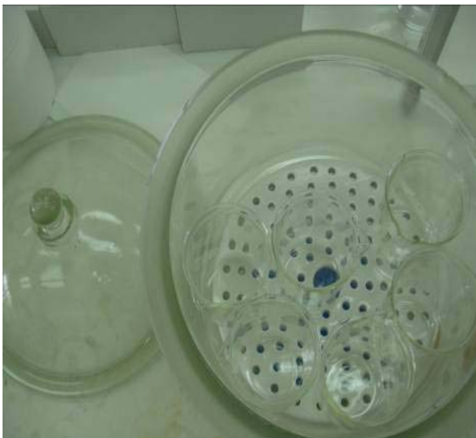
Εικόνα 21. Ξηραντήρας με Silica Gel και ποτήρια ζέσεως κατά την διαδικασία προσδιορισμού των ολικών στερεών.
