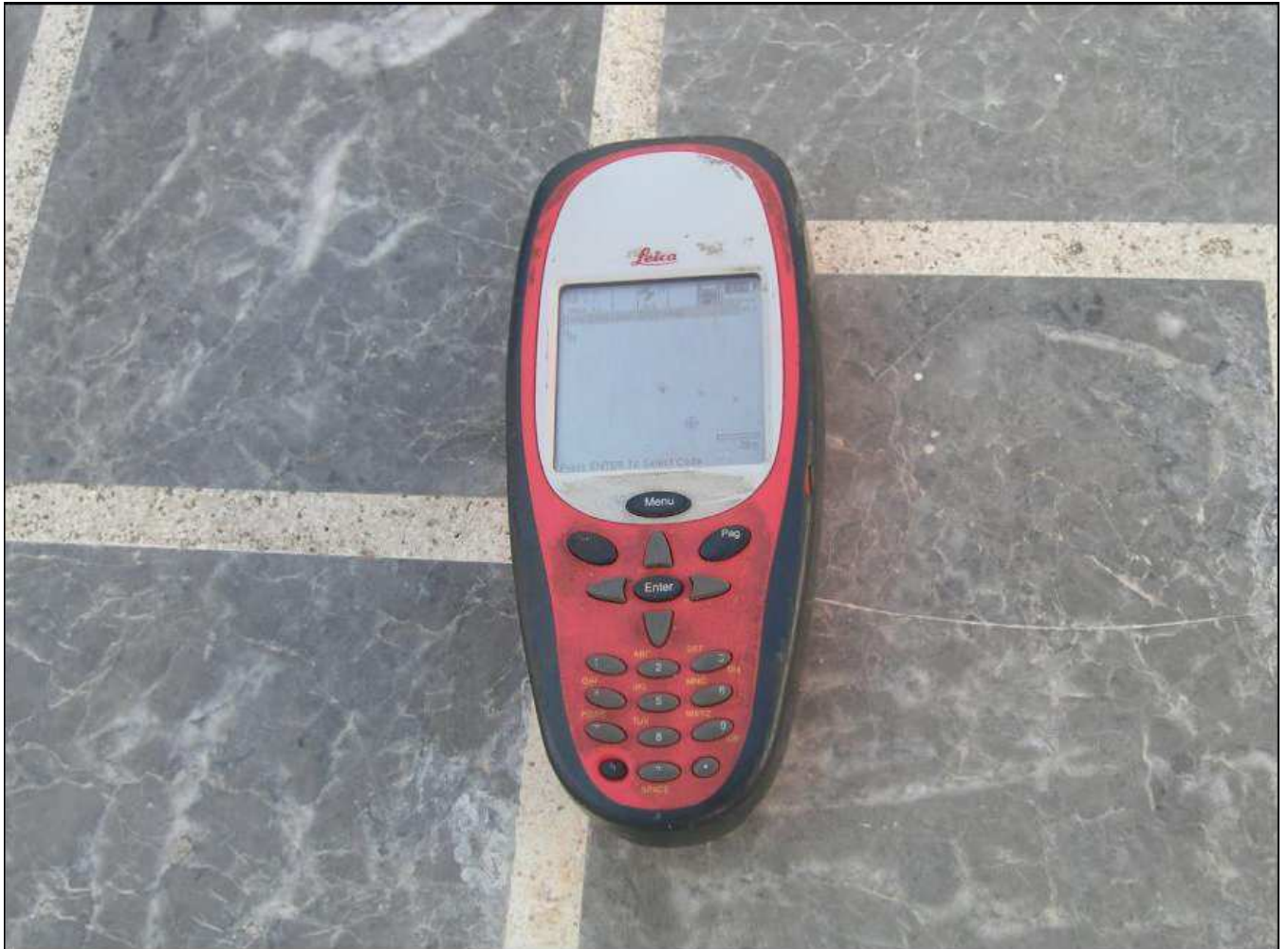
Εικόνα 4.4: Μονάδα GPS LEICA GS20 που χρησιμοποιήθηκε για την αποτύπωση των σημείων.
