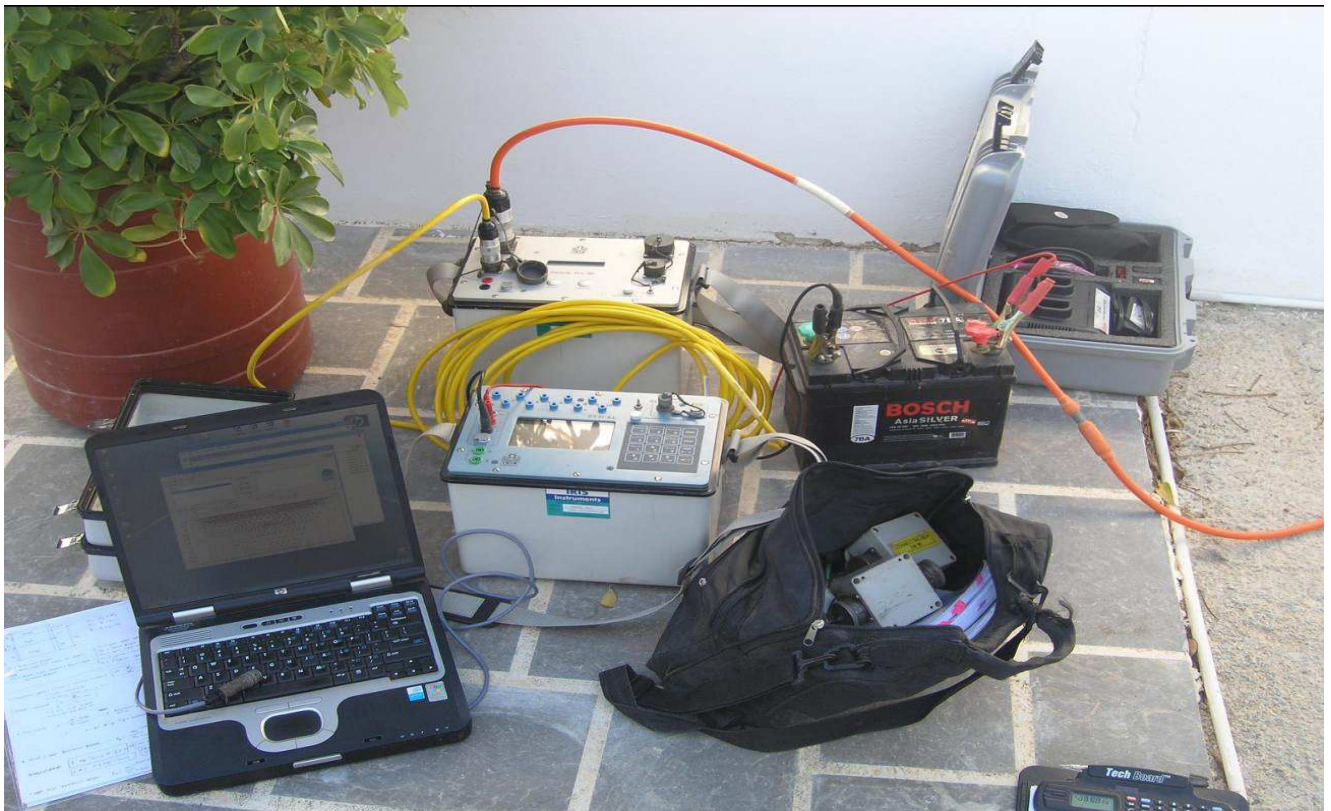
Εικόνα 4.1: Τρόπος σύνδεσης του οργάνου SYSCAL PRO με τον πολυπλέκτη SWITCH PRO για την αυτόματη μέτρηση και καταγραφή της φαινόμενης αντίστασης του υπεδάφους
