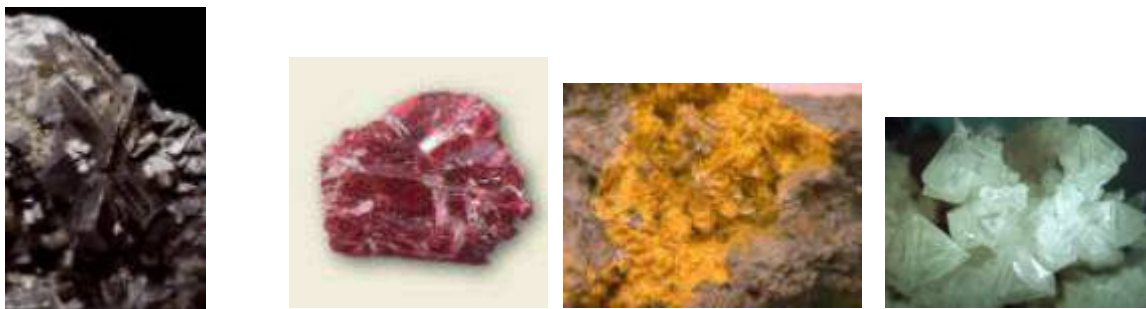
Εικόνα 13 Διάφορες μορφές αρσενικού arsenopyrite, realgar, orpiment, arsenolite.
