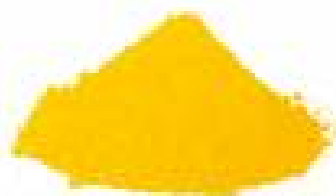
Εικόνα 19 Η μορφή του μολύβδου ως χρωμικό άλας μολύβδου.( www.galleries.com )
