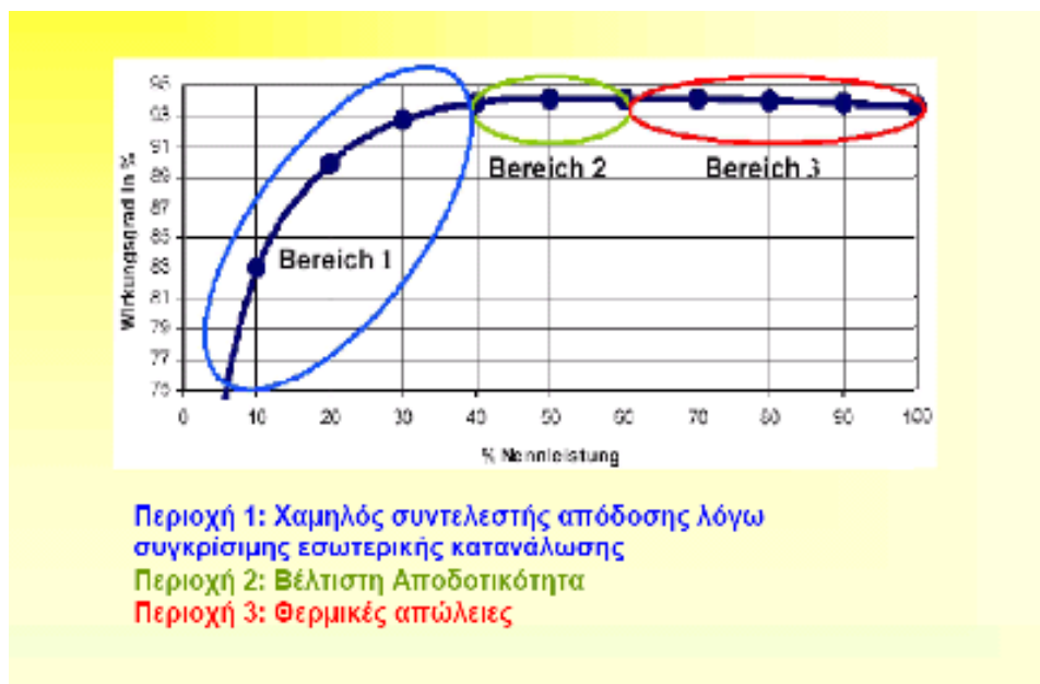
Σχήμα 34 Συντελεστής απόδοσης και απώλειες στους Μετατροπέες DC-AC
