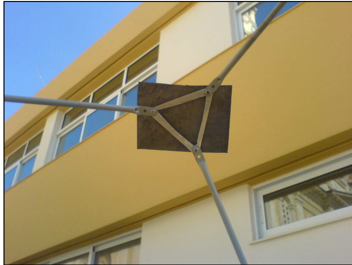
Σχήμα 5.13 Τοποθέτηση φύλλου μολύβδου στην απόσταση +2cm. Η βάση του Inb αντικαταστάθηκε από το τρίγωνο που φαίνεται στο σχήμα για να μην δημιουργείται σκίαση από αυτό.
