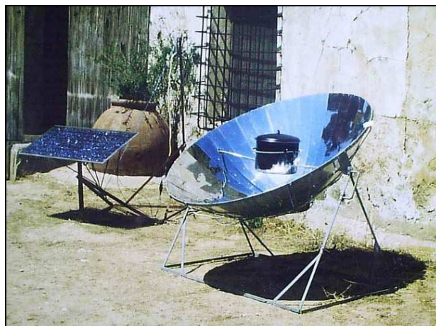
Σχήμα 3.19 Εφαρμογή παραβολικού συγκεντρωτή σαν « ηλιακό μαγειρείο».
