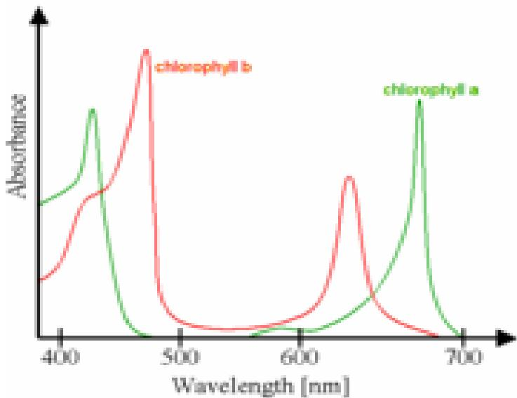
**Σχήμα 2.7 Φάσματα απορρόφησης χλωροφύλλης-*a* και -*b*.**
