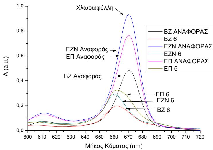
**Σχήμα 3.32** Σύγκριση δειγμάτων αναφοράς με τα αντίστοιχα τηγανισμένα ελαιόλαδα στα δείγματα BZ, EZN και ΕΠ.
