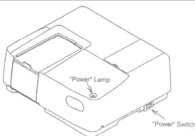
**Σχήμα 2.1** Στο πείραμα χρησιμοποιήθηκε φασματοφωτόμετρο τύπου JASCO V- 530.
