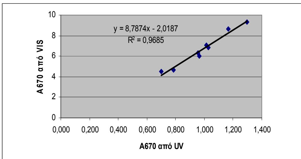
**Σχήμα 3.13** Συσχέτιση UV( A<sub>670</sub>) – VIS ppm χλωροφύλλης.
