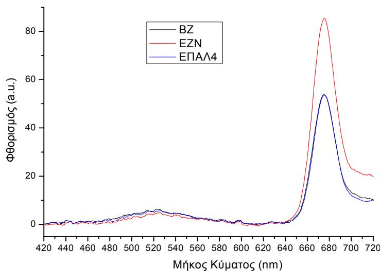
**Σχήμα 3.18** Τρία ελαιόλαδα (βιολογικό –τυποποιημένο -μη τυποποιημένο) τυπικό φάσμα φθορισμού (δείγμα από σειρά 3).
