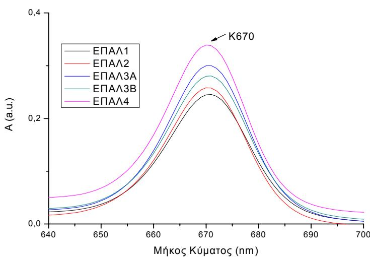
**Σχήμα 3.10** Φάσματα απορρόφησης ΕΠΑΛ ελαιολάδων στο VIS στην περιοχή 640-700 nm.
