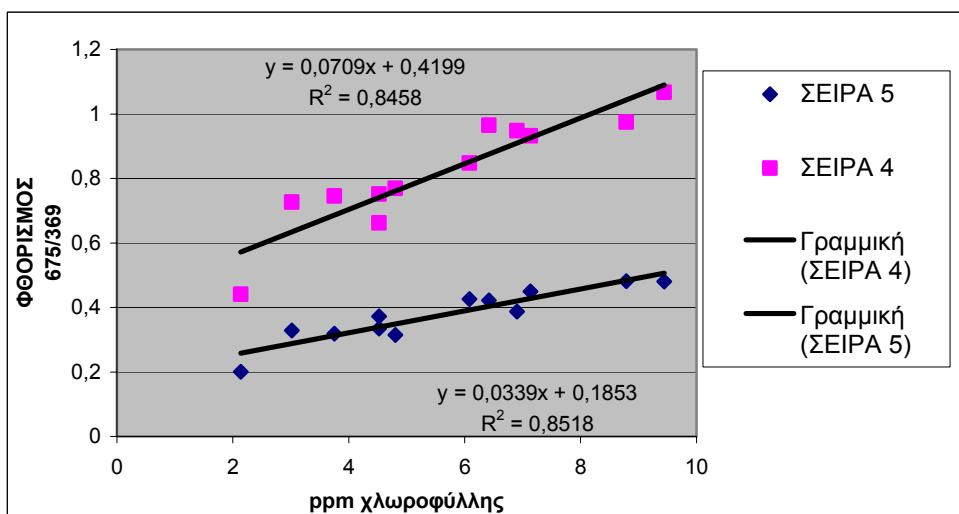
**Σχήμα 3.49** Συσχέτιση φθορισμού χλωροφύλλης – ppm χλωροφύλλης (σειρα4-σειρα5).
