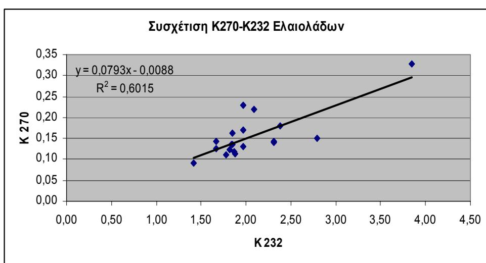
**Σχήμα 3.2** Συσχέτιση  $K_{270}$ - $K_{232}$  ελαιολάδων σε μετρήσεις UV.
