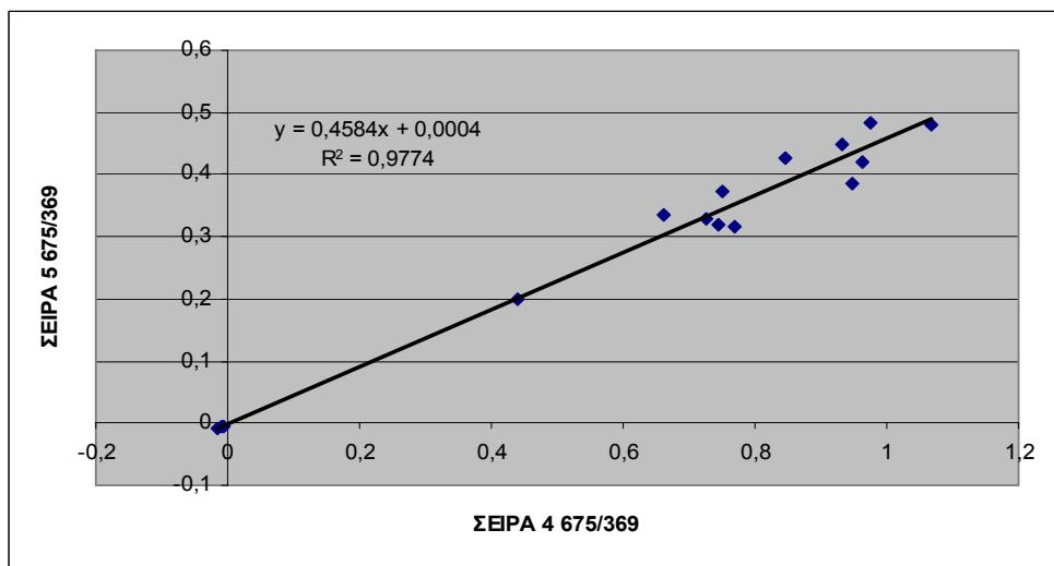
**Σχήμα 3.21** Συσχέτιση μεταξύ δύο σειρών φθορισμού χλωροφύλλης ελαιολάδων και σπορέλαιων(δείγμα από σειρές 4 και 5).
