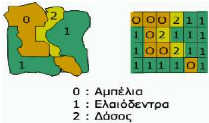
Εικόνα 2.2: Παρουσίαση δεδομένων σε μορφή διανύσματος (αριστερά) και σε μορφή καννάβου (δεξιά).
