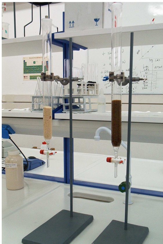
Εικόνα 29. Στήλες με ρητίνες που χρησιμοποιήθηκαν στο πείραμα
