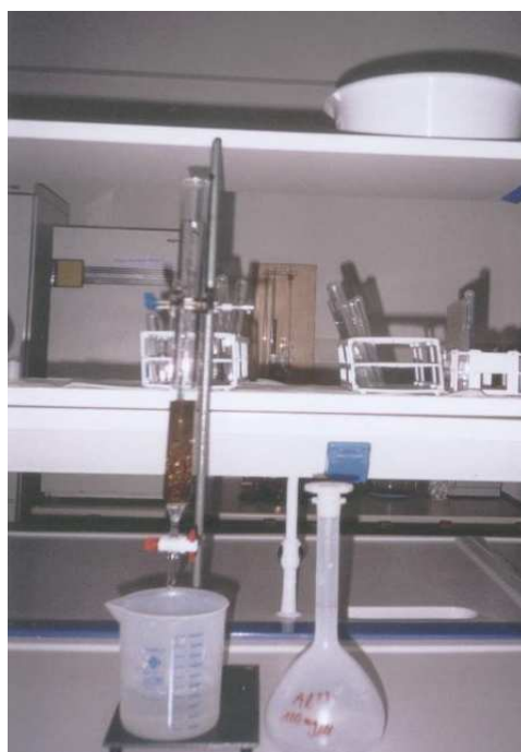
Εικόνα 35. Το διάλυμα \text{AlK}_2\text{O}_8\text{S}_2 \cdot 12 \text{H}_2\text{O} πέρασε από την κατιονική ρητίνη
