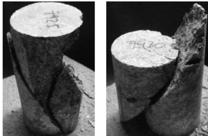
Σχήμα 1.6. Αποτέλεσμα μονοαξονικής συμπίεσης μέχρι θραύσης σε κυλινδρικό δοκίμιο πετρώματος.
