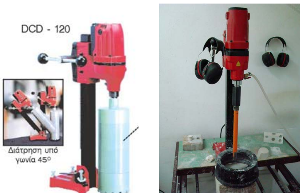
Σχήμα 2.11. Το τρυπάνι που χρησιμοποιήθηκε για την εξαγωγή κυλινδρικών δοκιμίων από διάφορα πετρώματα.
