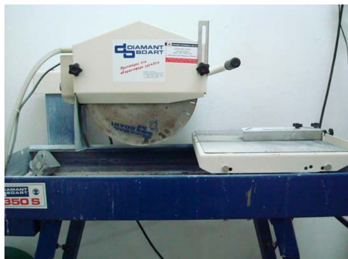
Σχήμα 2.12. Το δισκοπρίονο που χρησιμοποιήθηκε για την κοπή των δοκιμίων σε καθορισμένο μήκος
