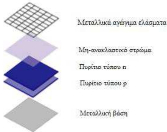
Σχήμα 2.6: Δομή ηλιακής κυψέλης
