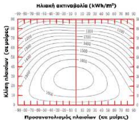
Σχήμα 4.11: Επίδραση της τιμής της κλίσης και του προσανατολισμού στην διαθέσιμη ηλιακή ακτινοβολία (kWh/m 2 /έτος) στο επίπεδο των ηλιακών πλαισίων ενός κτιριακού φωτοβολταϊκού συστήματος στην Αττική.
