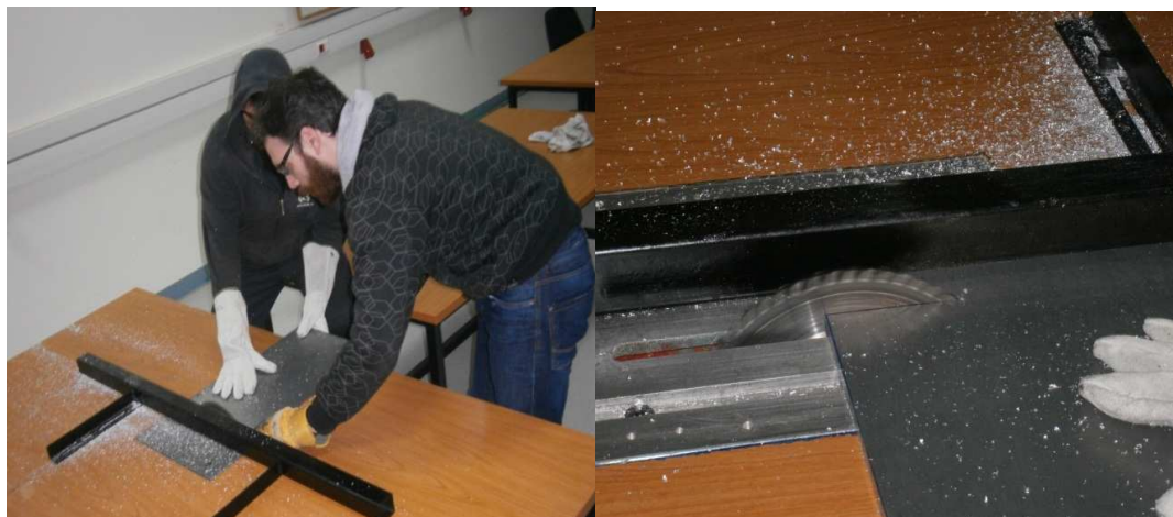
όνα 63. Κοπή των ελασμάτων αλουμινίου στο δισκοπρίονο.
