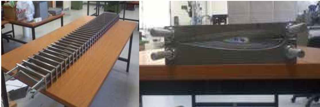
Εικόνα 79. Πλήρες συναρμολόγημα σκελετού καλουπιού.
