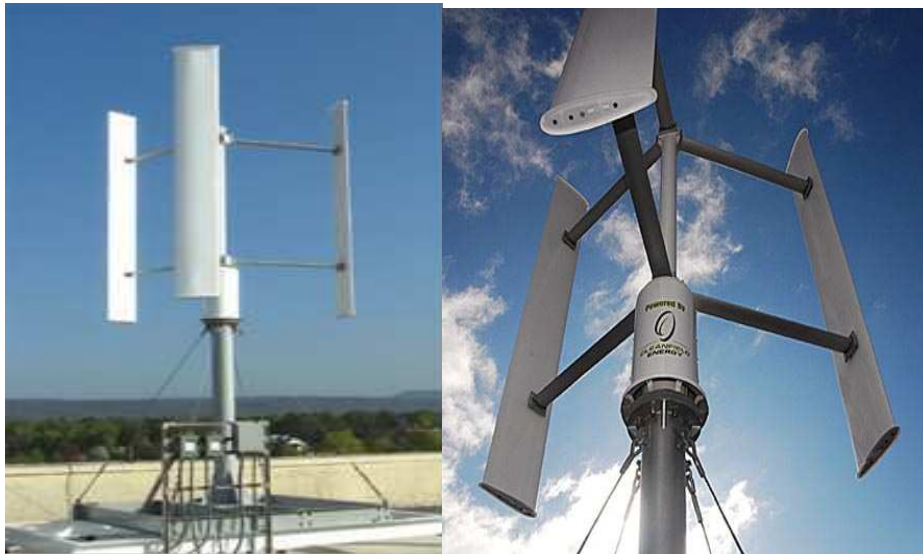
Εικόνα 10. Ανεμογεννήτριες Darrieus τύπου-H
