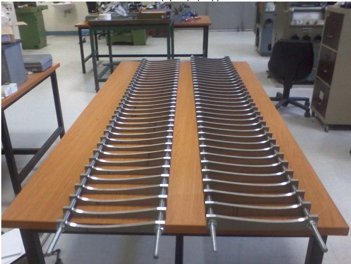
Εικόνα 78. Άνω και κάτω τμήμα συναρμολογήματος σκελετού καλουπιού.
