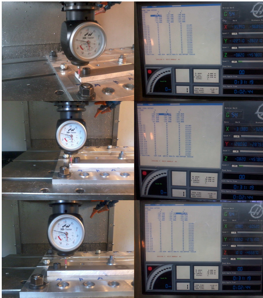
Εικόνα 68. Μηδενισμός αξόνων X,Y,Z
