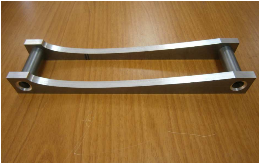
Εικόνα 75 Συναρμολόγηση δύο ελασμάτων και δύο αποστατών
