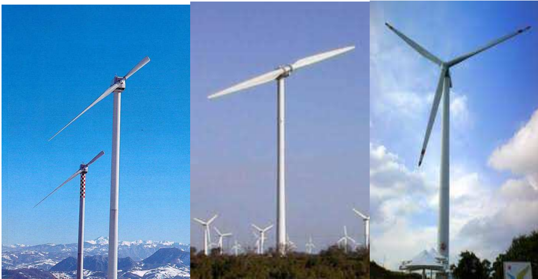
Εικόνα 3. Μονόπτερη, δίπτερη και τρίπτερη ανεμογεννήτρια οριζοντίου άξονα.
