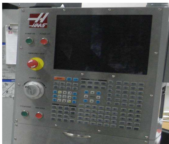
Εικόνα 62. Πίνακας χειρισμού της εργαλειομηχανής CNC VF1.
