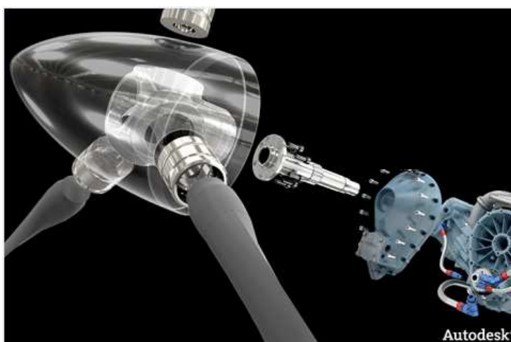
Εικόνα 23. Κομμάτια (Parts) ανεμογεννήτριας που συναρμολογούνται σε περιβάλλον Συναρμολογήματος (Assembly).
