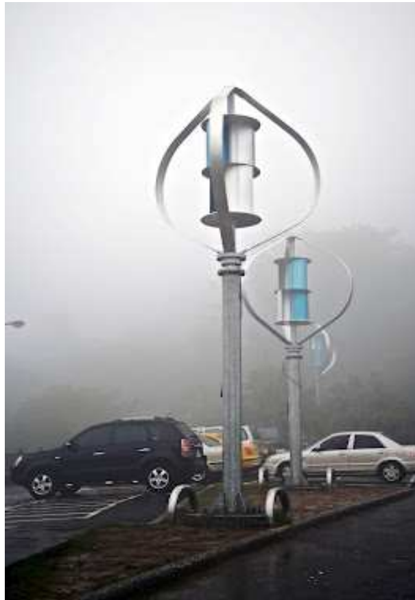
Εικόνα 9. Ανεμογεννήτρια Darrieus με βοηθητική Savonius
