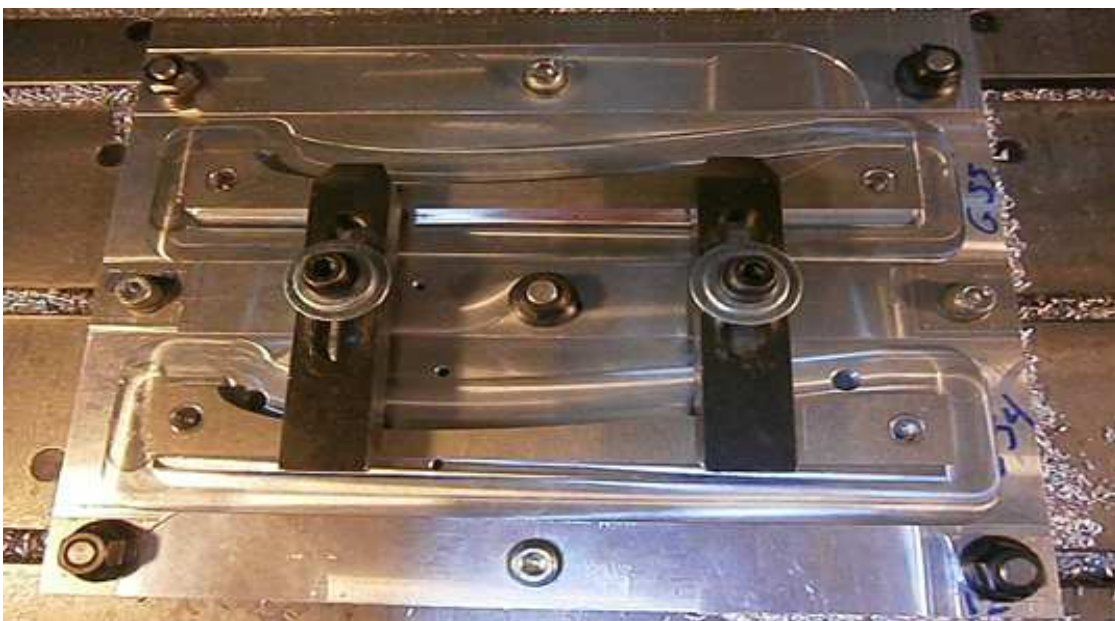
Εικόνα 73. Συγκράτηση ελασμάτων για δημιουργία πατούρας και οπής.
