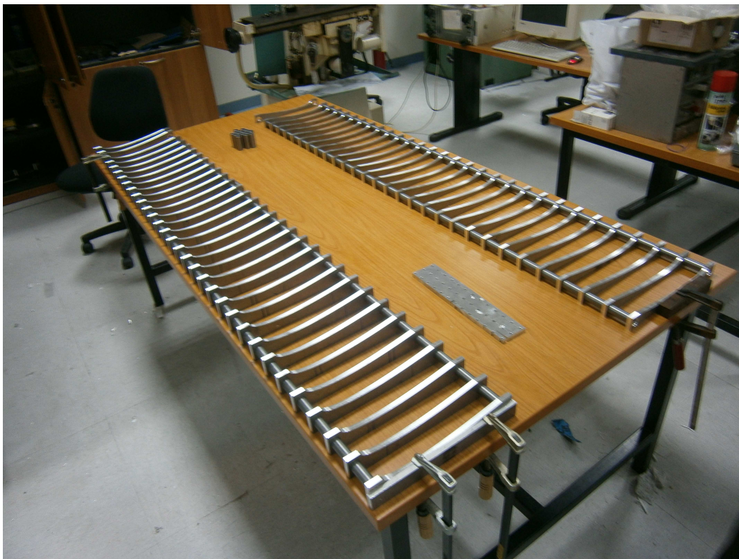
Εικόνα 76. Συναρμολογήματα άνω και κάτω τμημάτων σκελετού καλουπιού.
