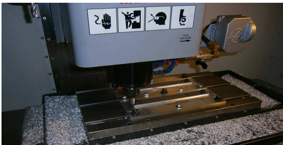
Εικόνα 70. Μετωπικό φρεζάρισμα ελάσματος.
