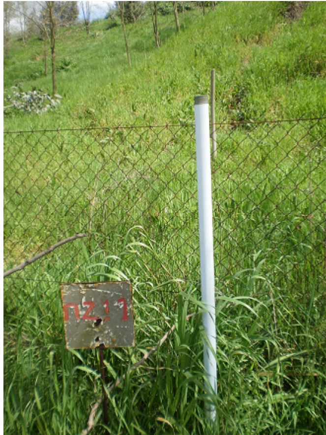
Εικόνα 3: Πιεζόμετρο στο ορυχείο της Μεγαλόπολης.
