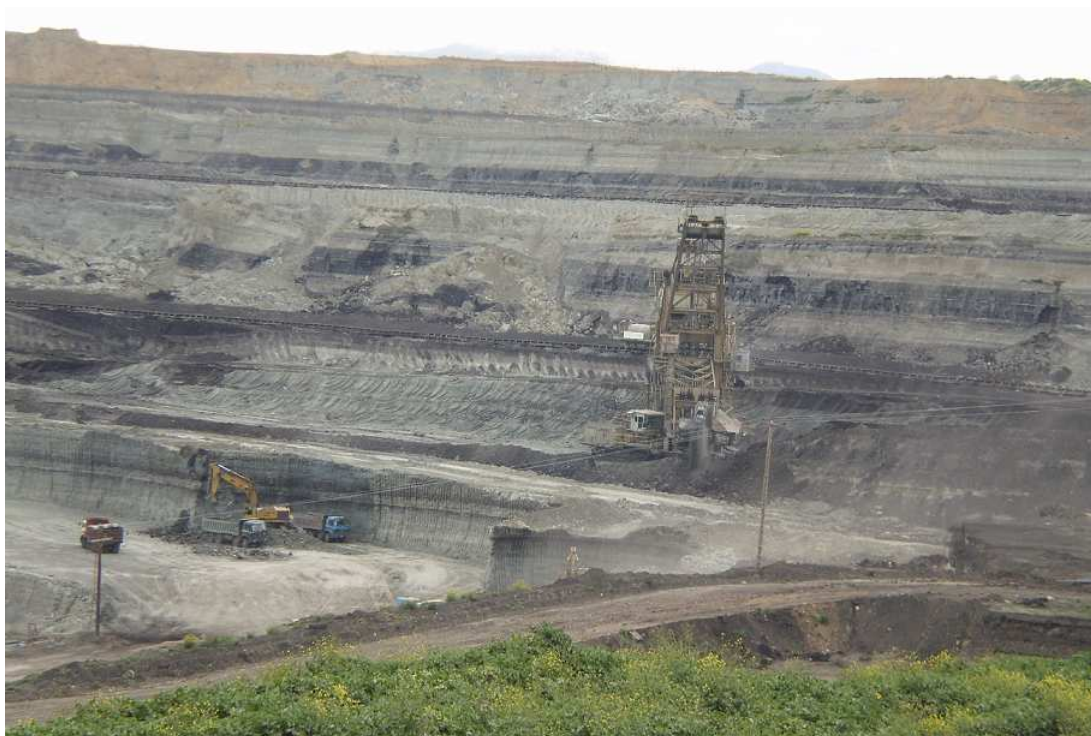
Εικόνα 5: Εξόρυξη λιγνίτη στο ορυχείο της Μεγαλόπολης καθώς και τα επίπεδα εκμετάλλευσης, το πρανές καφέ χρώματος ήταν η αρχική εκμετάλλευση.
