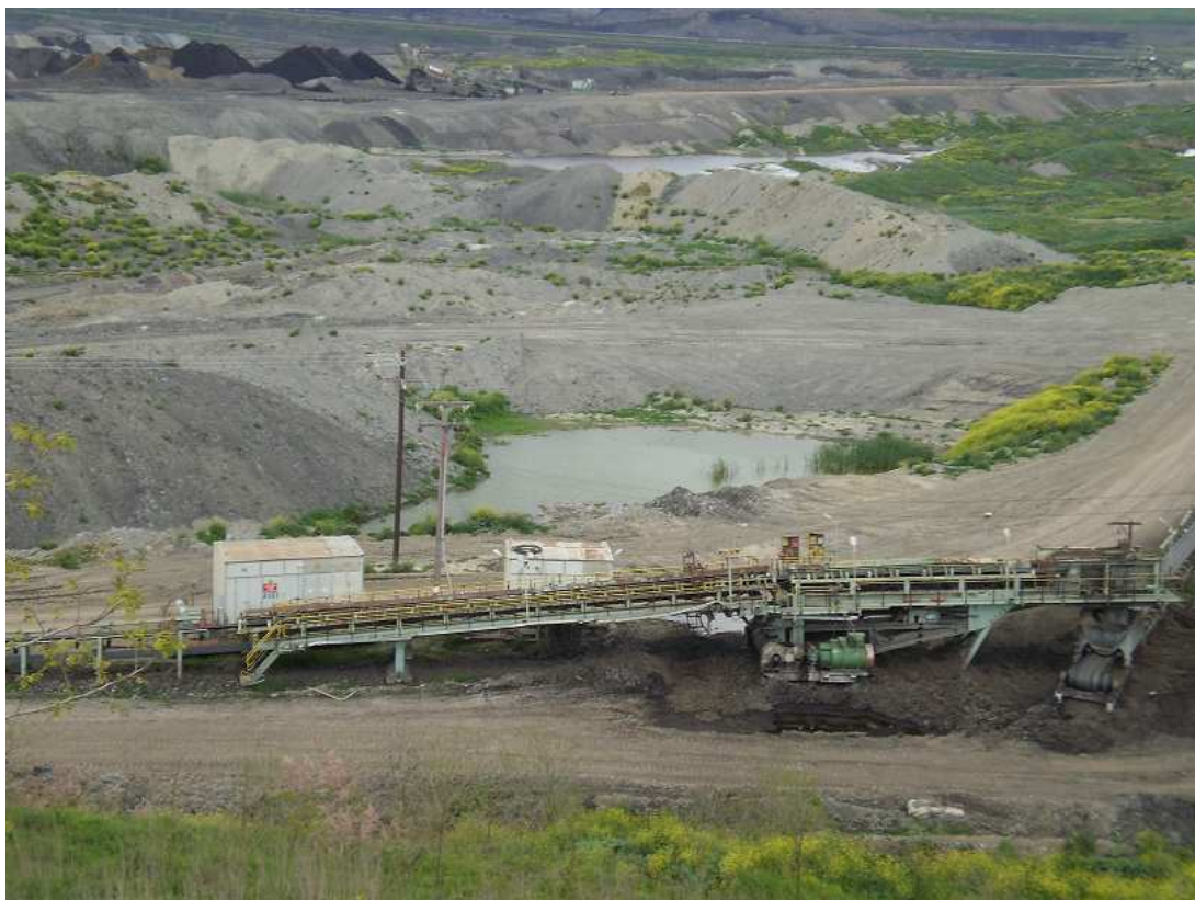
Εικόνα 7: Ταινιόδρομος μεταφοράς λιγνίτη στο ορυχείο της Μεγαλόπολης και στο βάθος διακρίνονται δυο αντλιοστάσια.
