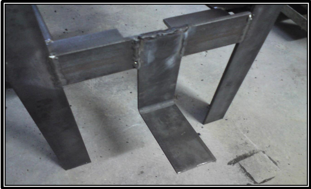
Εικόνα 4.19 Συγκόλληση βάση στήριξης αντλίας.
