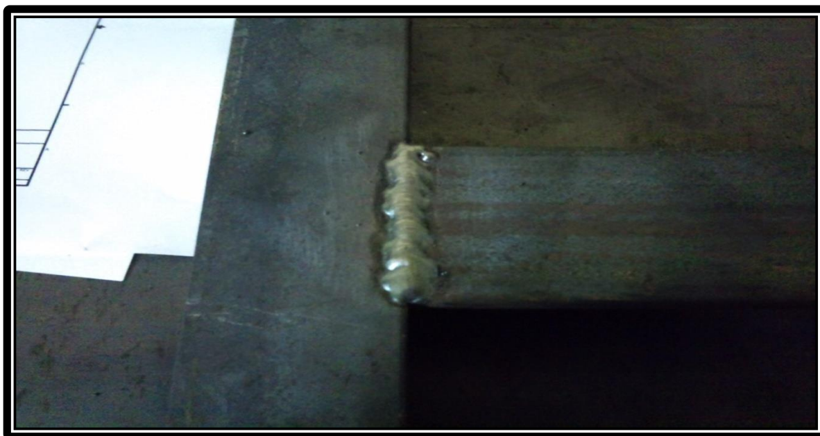
Εικόνα 4.9 Συγκόλληση οπίσθιας βάση στήριξης με πρώτο πόδι.
