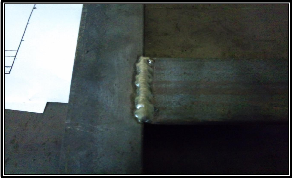
Εικόνα 4.7 Ηλεκτροσυγκόλληση πρώτου ποδιού με την πρόσθια βάση στήριξης.
