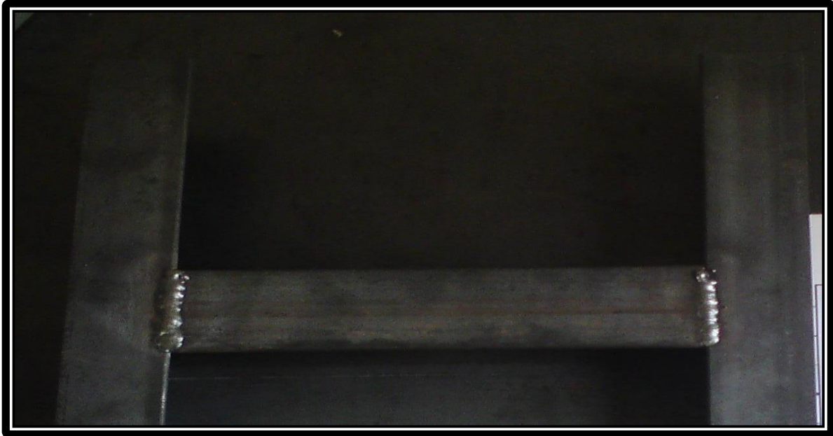
Εικόνα 4.10 Συγκόλληση δεύτερο ποδιού στην βάση στήριξης.
