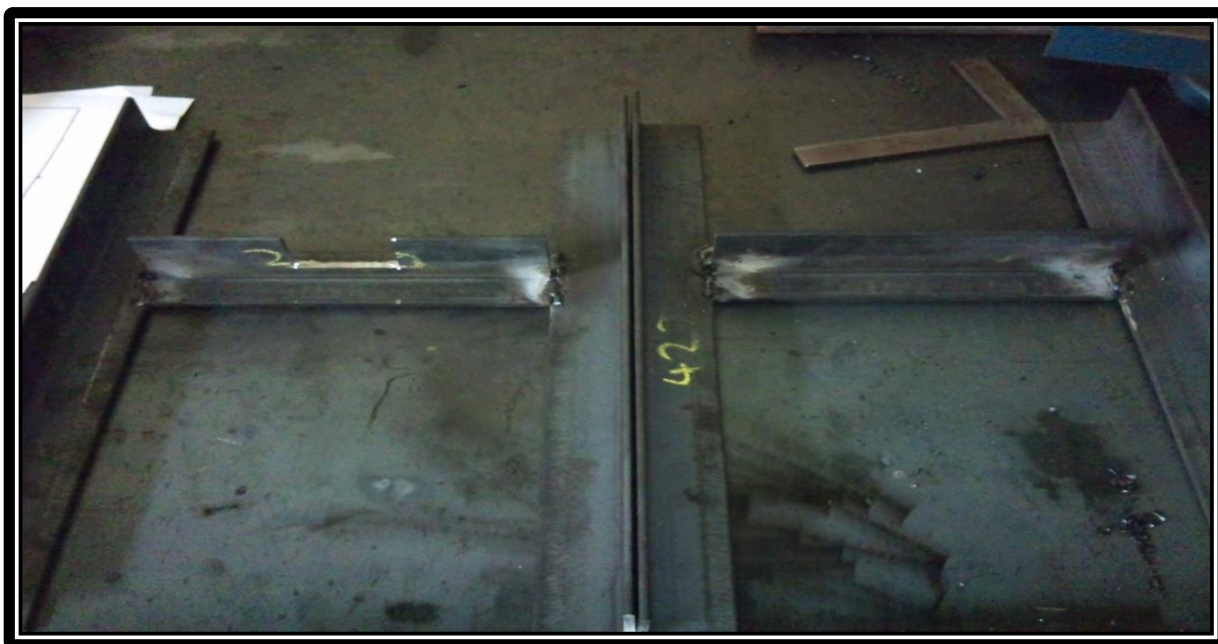
Εικόνα 4.12 Ενίσχυση κόλλησης των ποδιών στήριξης.
