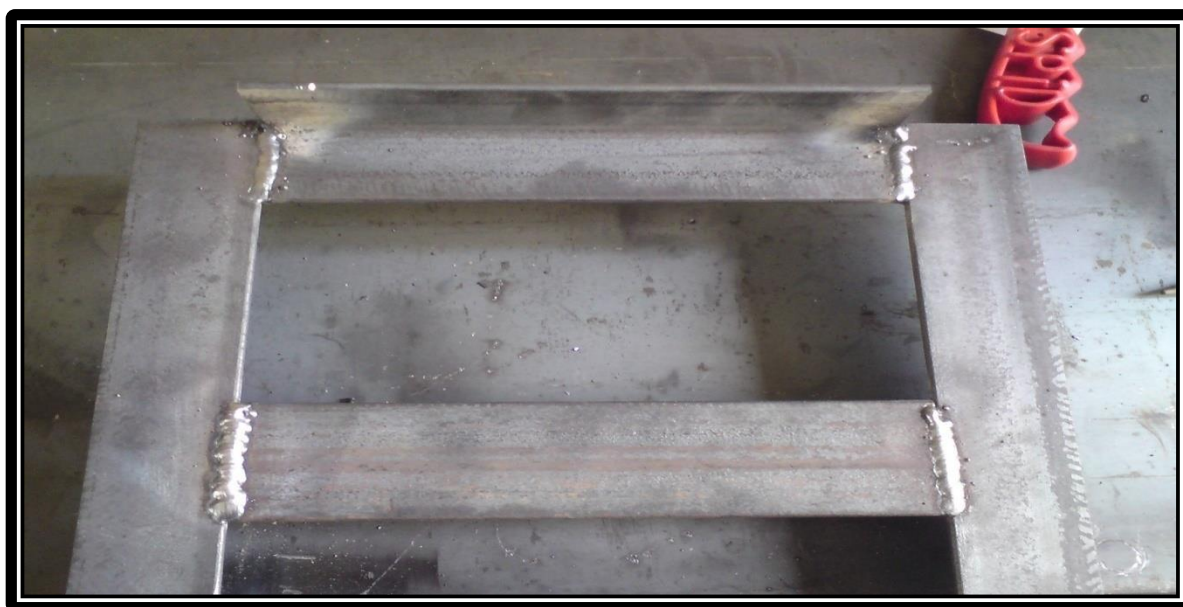
Εικόνα 4.13 Συγκόλληση βάσεων στήριξης εσοχών εισόδου και εξόδου.
