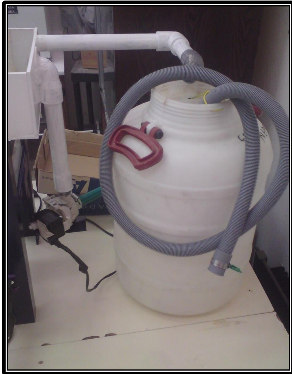
Εικόνα 4.21 Δοχείο ανάδευσης ιζημάτων και αντλία εισόδου.
