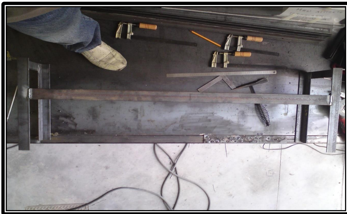
Εικόνα 4.17 Συγκόλληση της δεύτερης πλευρικής βάσης στήριξης.
