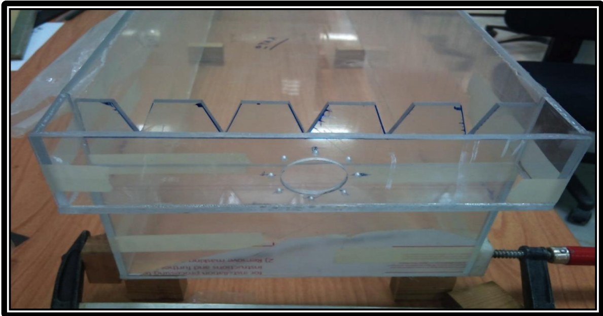
Εικόνα 4.2 Συναρμολόγηση οπίσθιας όψης δεξαμενής καθίζησης.
