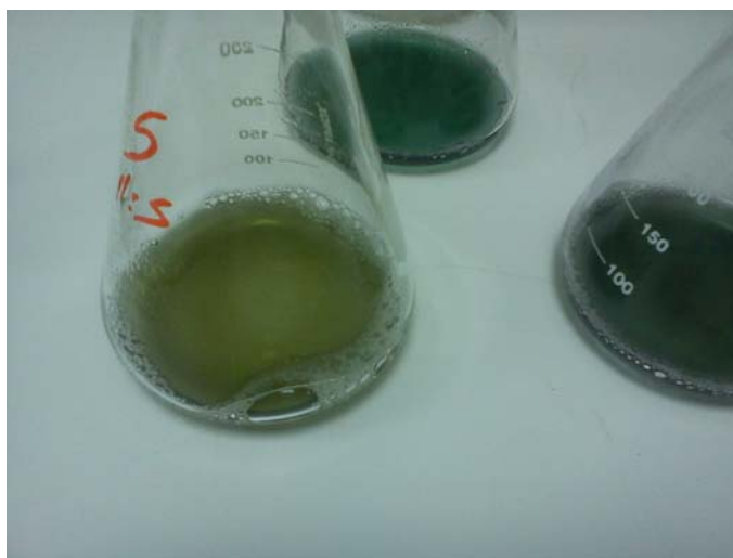
Εικόνα 7. Κωνικές φιάλες, των 250 ml, με δείγμα νερού μετά από ογκομέτρηση με EDTA.
