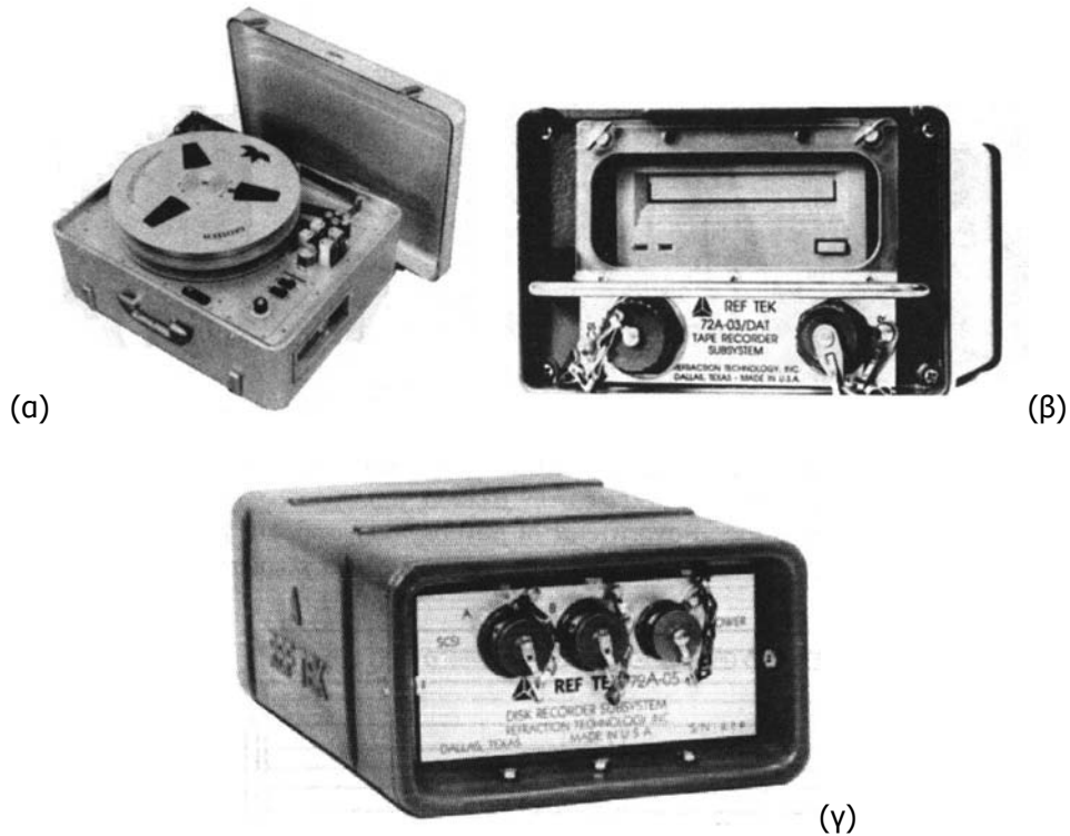
Σχήμα 37. Μερικά συστήματα αποθήκευσης σεισμολογικών δεδομένων που χρησιμοποιούν σύγχρονοι σειсмоγράφοι, α) Αναλογικής σε ταινία, β) Ψηφιακής σε ταινία, γ) Σκληρού δίσκου (Τσελέντης, 1997).
