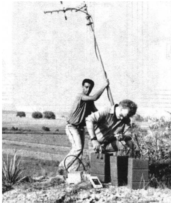
Σχήμα 38: Εγκατάσταση φορητού σεισμογράφου με σύστημα ραδιομετάδοσης. Διακρίνεται η κατευθυνόμενη κεραιά αποστολής της πληροφορίας (Τσελέντης, 1997).
